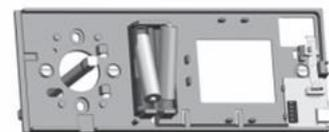
Abb. 4.6: Batterien austauschen. Montage in umgekehrter Reihenfolge.
