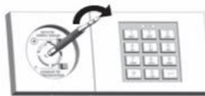
Abb. 5.5: Schlüssel im Uhrzeigersinn bis zum Anschlag drehen
