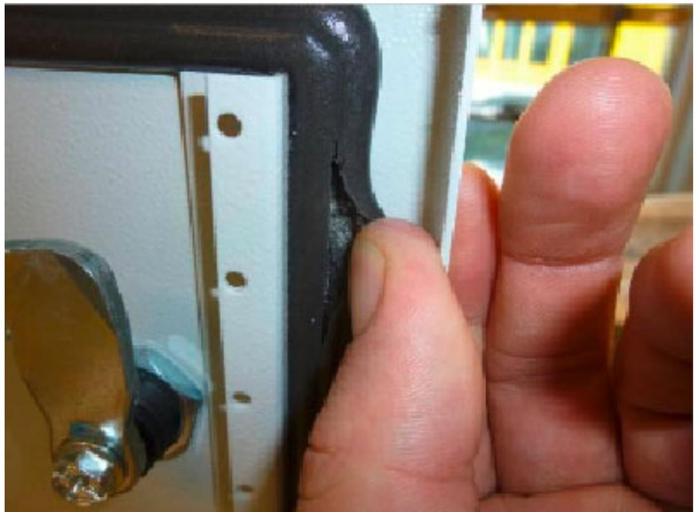
Abbildung 5: Auswirkungen von einem IK-Test
