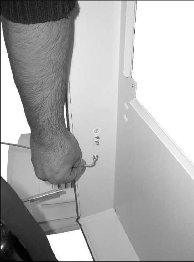
Imagen 77: Desconectar el cable de puesta a tierra (2)
