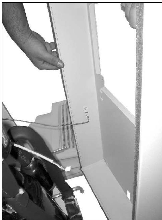
Imagen 76: Desconectar el cable de puesta a tierra (1)
