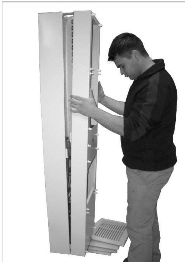
Imagen 75: Desmontaje de la cubierta
