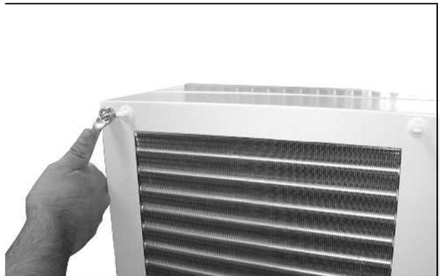
Imagen 48: Desmontar la cubiorta (soltar las cuatro tuercas)
