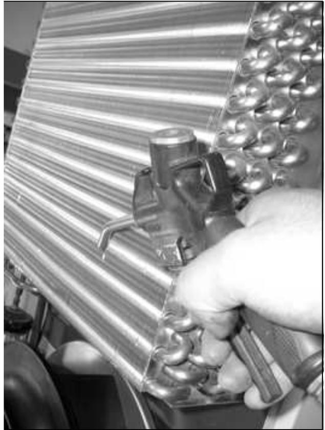
Fig. 79 : Nettoyer l'unité d'échange thermique et l'espace compresseur à l'air comprimé (2)
