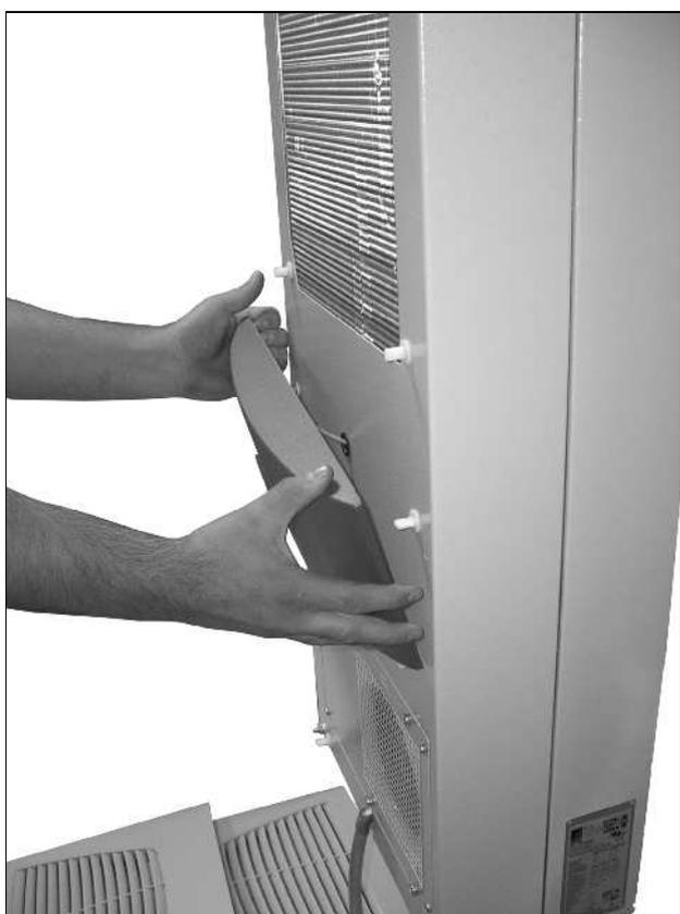
Fig. 41 : Retirer le plastron
