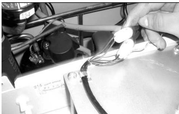
Fig. 70 : Débrancher les fiches de raccordement du ventilateur (2)
