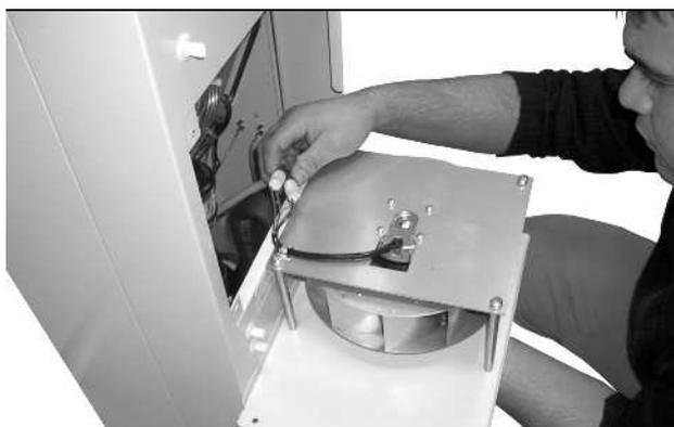
Fig. 69 : Débrancher les fiches de raccordement du ventilateur (1)
