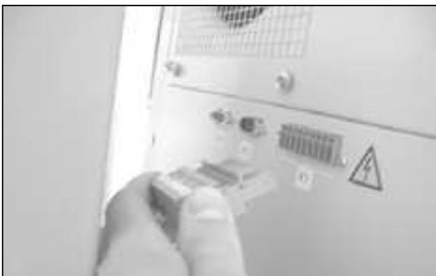
Fig. 57 : Couper l'alimentation en débranchant la fiche
