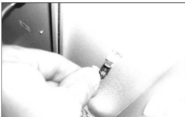
Fig. 73 : Retirer le câble de mise à la masse du ventilateur (2)
