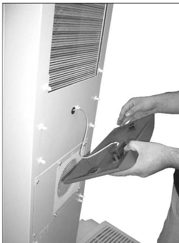
Fig. 63 : Retirer le plastron
