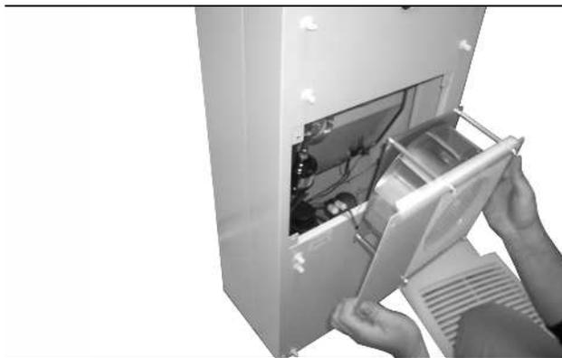
Fig. 68 : Démontez le ventilateur du circuit externe
