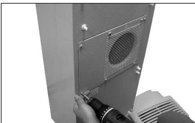
Fig. 67 : Dévisser les quatre vis du ventilateur du circuit externe
