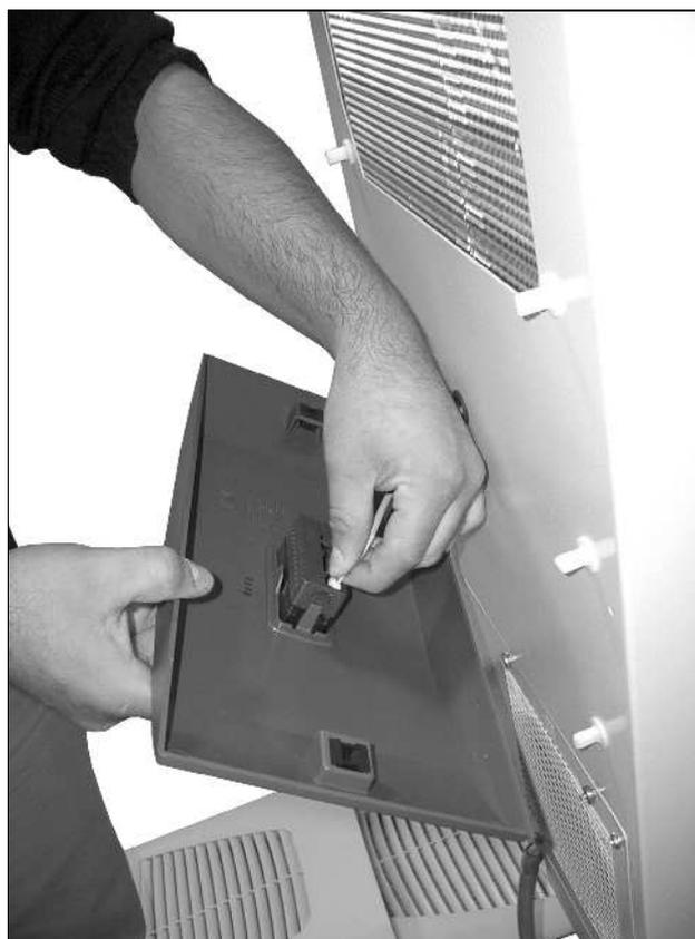
Fig. 42 : Débrancher la fiche de connexion de l'afficheur (1)
