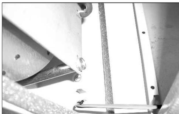
Fig. 53 : Retirer le câble de mise à la terre qui se trouve entre le capot et le châssis (1)
