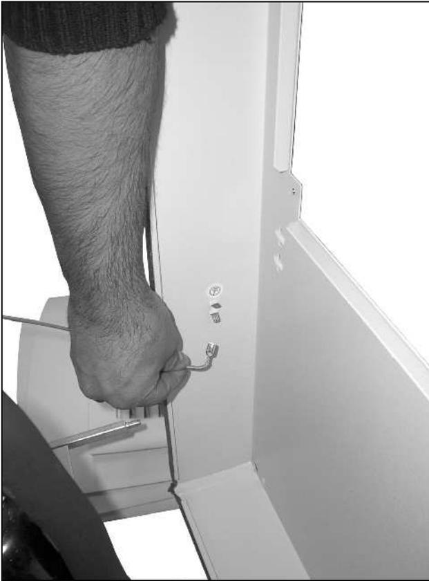
Fig. 77 : Retirer le câble de mise à la masse (2)
