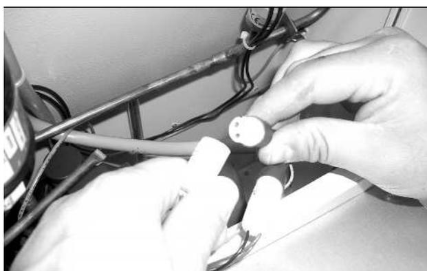
Fig. 71 : Débrancher les fiches de raccordement du ventilateur (3)
