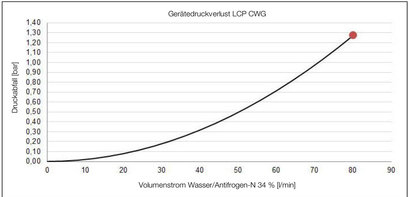
Abb. 124: Druckverlust im LCP CWG
