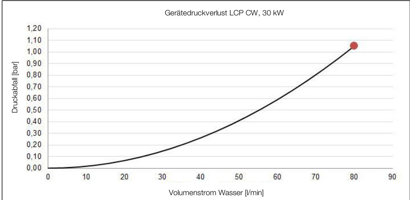
Abb. 122: Druckverlust im LCP CW in der Ausführung „30 kW“
