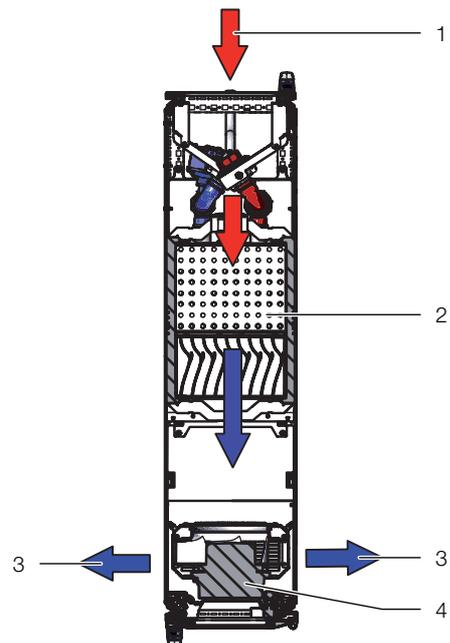
Abb. 2: Luftführung am LCP Inline Protruding – Draufsicht
