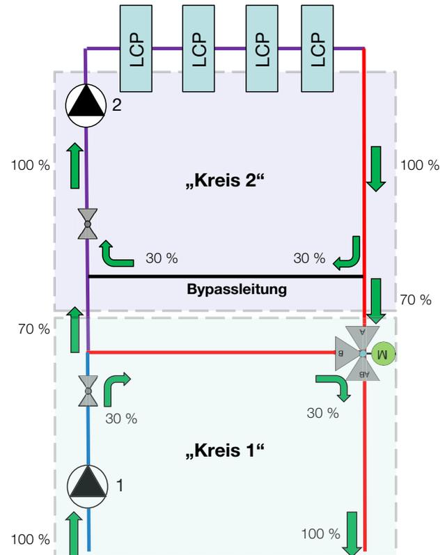
Abb. 81: Einspritzschaltung (Prinzipschema)
