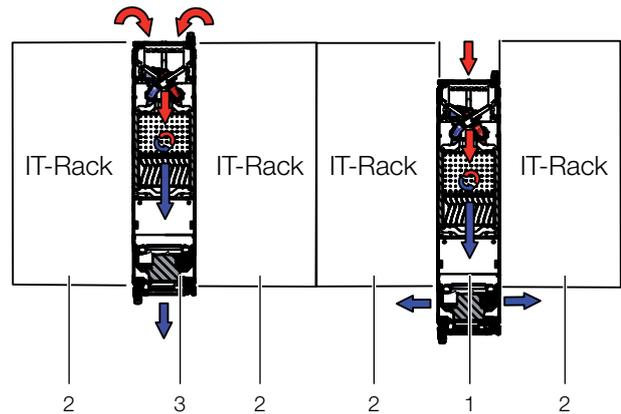
Abb. 11: Luftführung bei angereicherten Serverschränken – Draufsicht
