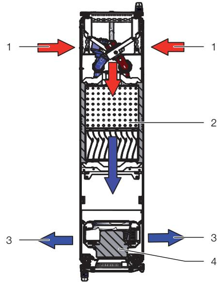
Abb. 1: Luftführung am LCP Rack – Draufsicht
