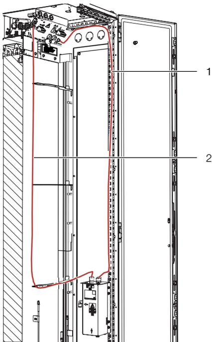
Abb. 62: Verlegung der Anschlusskabel
