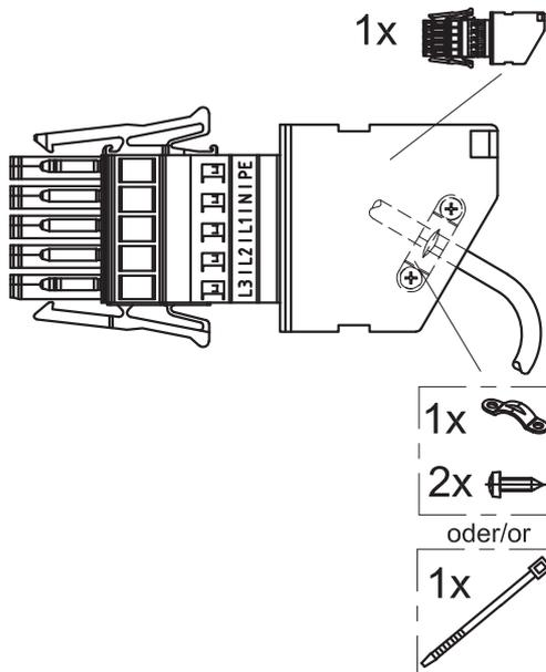
Abb. 71: Schema des Anschlusssteckers für dreiphasigen Anschluss – globale Version
