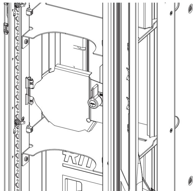
Abb. 52: Einsetzen der Lüftertür
