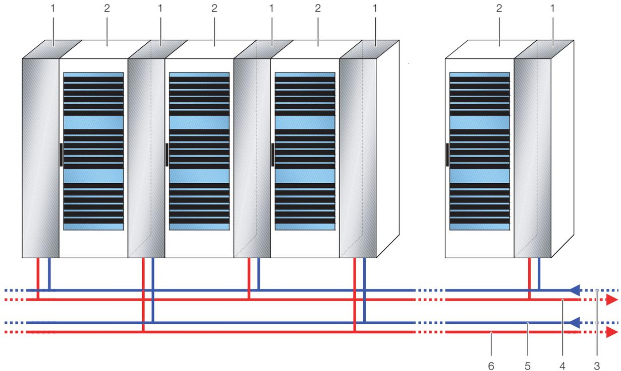
Abb. 19: Redundante Kühlung und doppelte, abwechselnde Wasserversorgung
