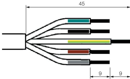
Abb. 70: Maße zum Entfernen der Gummimantelung und der Isolierung
