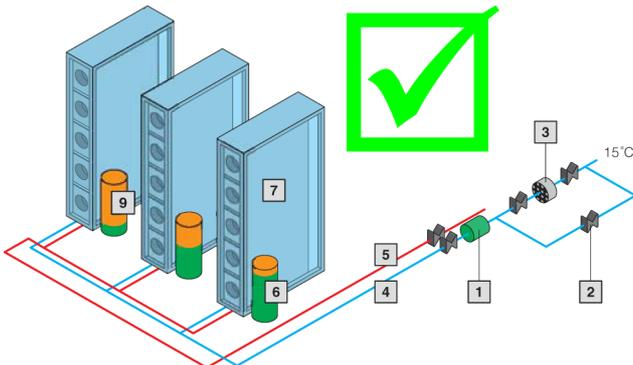
Abb. 84: Kälteverteilung mit Tichelmann-Prinzip
