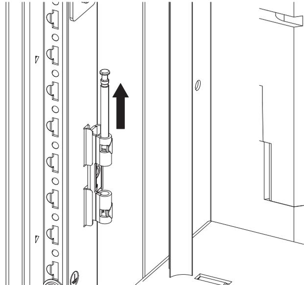
Abb. 51: Öffnen der Scharnierbolzen
