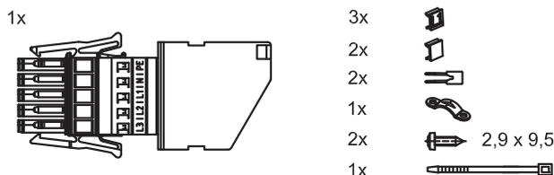
Abb. 69: Lieferumfang des Anschlusssteckers
