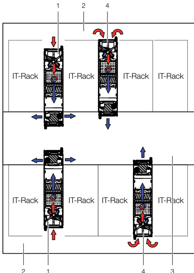
Abb. 27: Aufstellraum mit Kaltgang-Schottung
