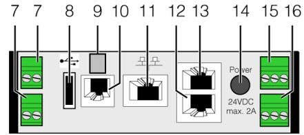
Abb. 91: Regeleinheit Liquid Cooling Package (CMC III PU) – Rückseite
