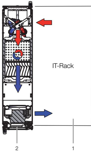
Abb. 9: Luftführung bei einem angereicherten Serverschrank – Draufsicht
