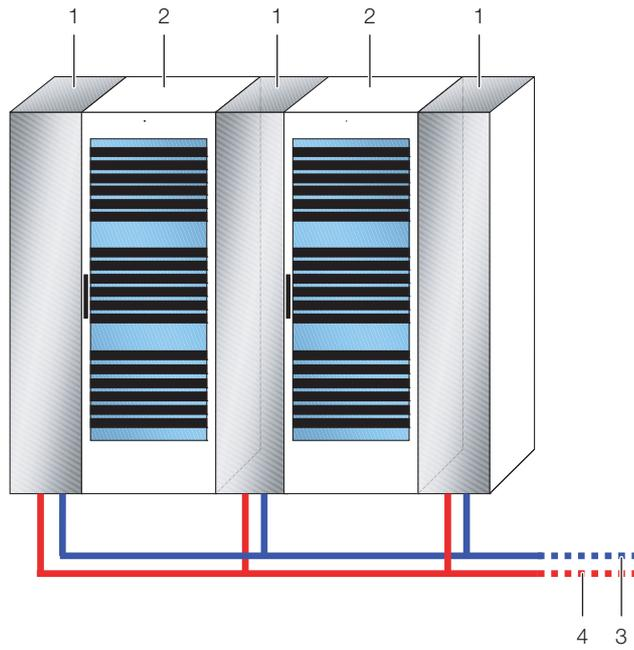
Abb. 18: Redundante Kühlung mit drei LCP Rack
