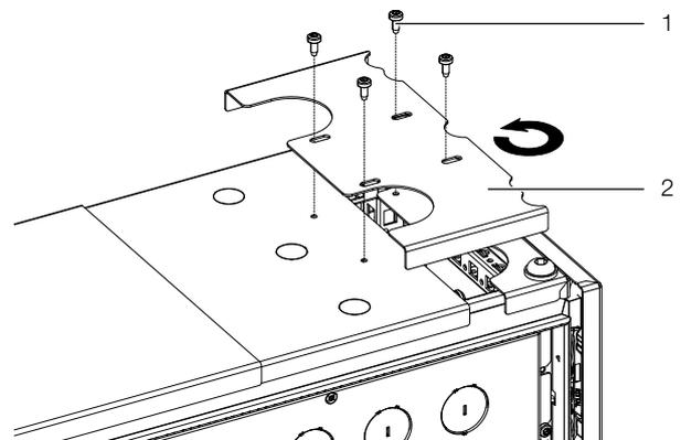
Abb. 79: Drehen des Dachblechs
