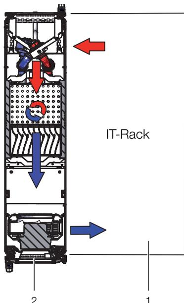
Abb. 132: „Front to Back“-Kühlprinzip mit angereichertem LCP Rack
