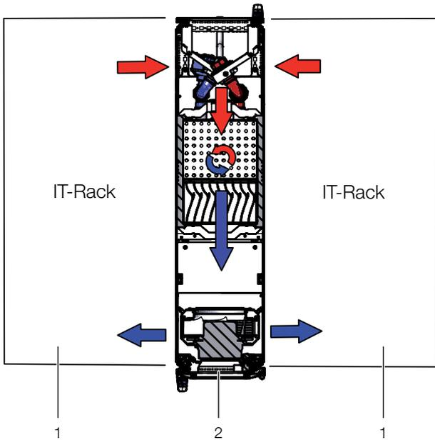
Abb. 10: Luftführung bei zwei angereicherten Serverschränken – Draufsicht
