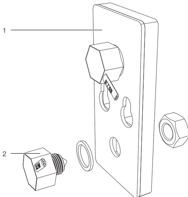
Abb. 67: Befestigung des Niveausensors
