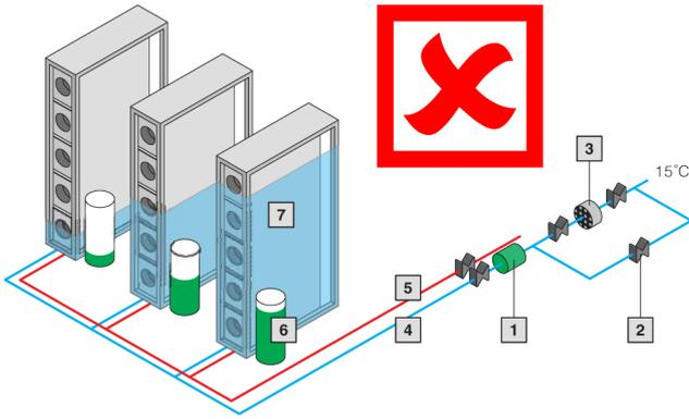
Abb. 82: Kälteverteilung ohne hydraulischen Abgleich
