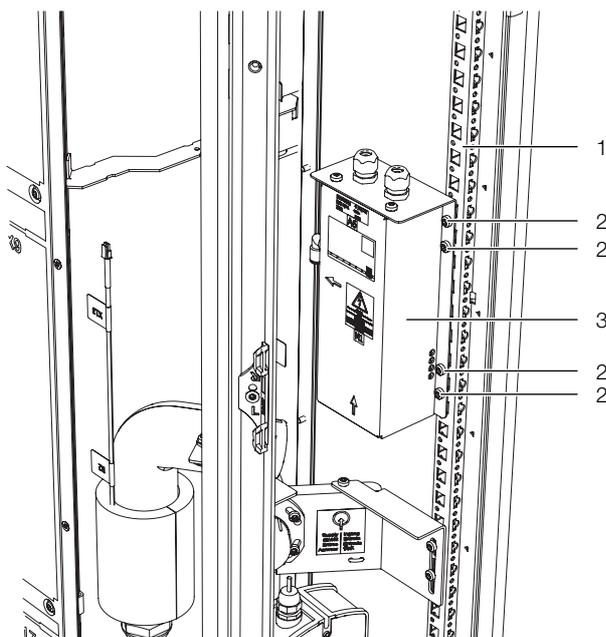
Abb. 59: Befestigen der Kondensatpumpe
