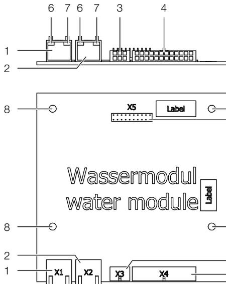
Abb. 130: Regeleinheit Wassermodule – Rückseite/Draufsicht
