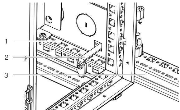
Abb. 36: Verbindungselement im hinteren Bereich VX/TS
