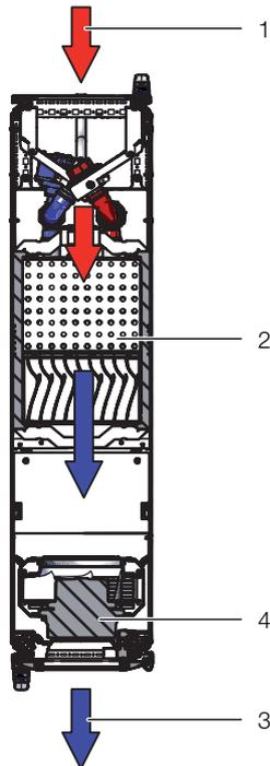
Abb. 3: Luftführung am LCP Inline Flush – Draufsicht
