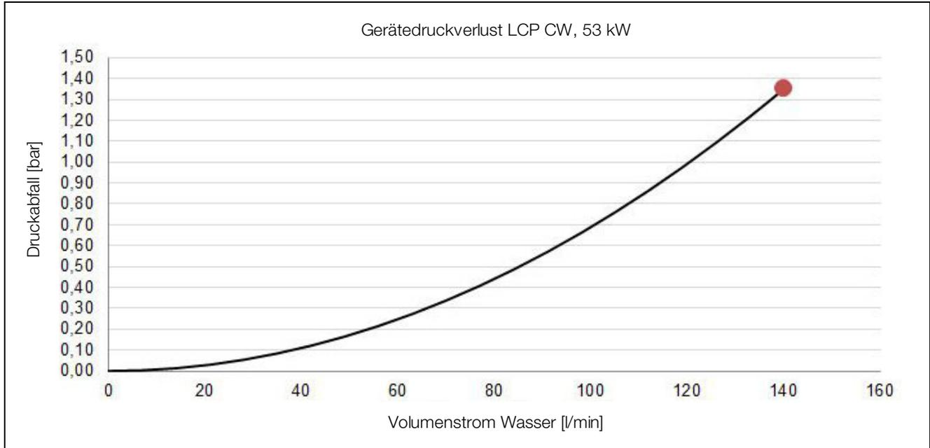
Abb. 123: Druckverlust im LCP CW in der Ausführung „53 kW“
