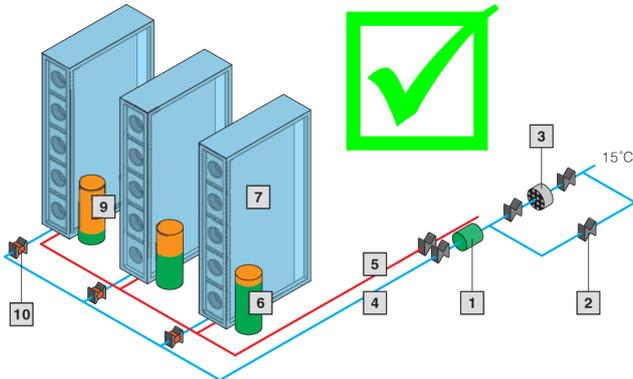
Abb. 83: Kälteverteilung mit hydraulischem Abgleich
