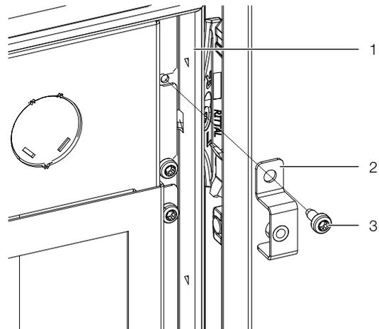
Abb. 39: Montage Winkel zur Befestigung der Seitenwand
