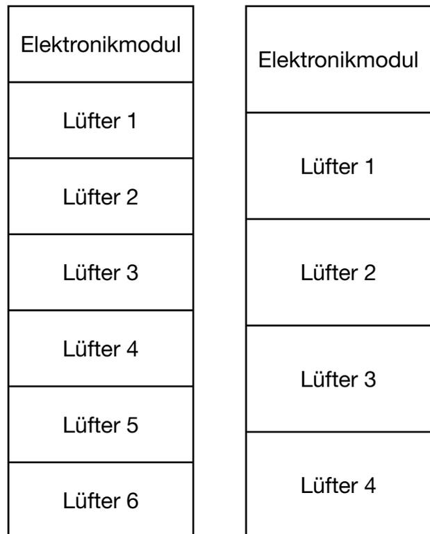
Abb. 45: Lüfterpositionen LCP Rack und LCP Inline Protruding (links) sowie LCP Inline Flush (rechts)
