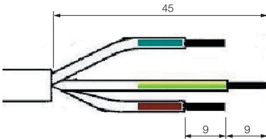
Abb. 75: Maße zum Entfernen der Gummiummantelung und der Isolierung
