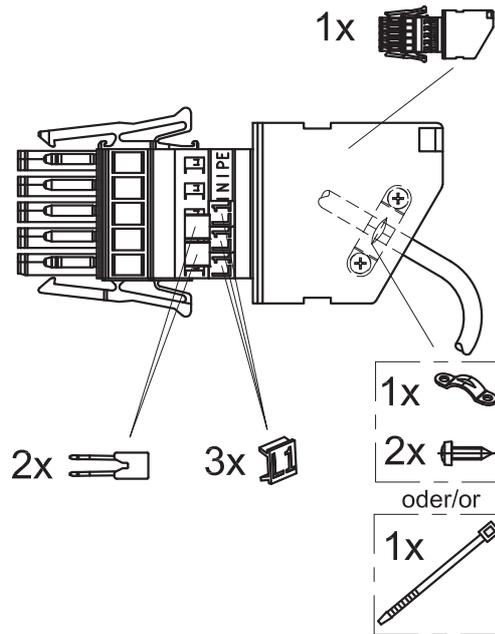
Abb. 76: Schema des Anschlusssteckers für einphasigen Anschluss – globale Version
