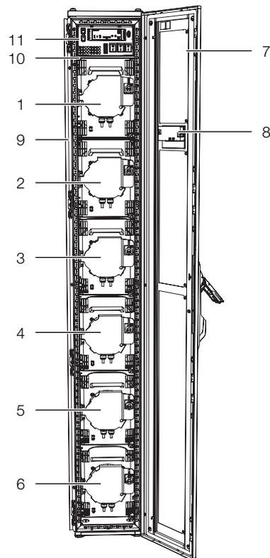
Abb. 13: Liquid Cooling Package Vorderseite – Fronttür geöffnet
