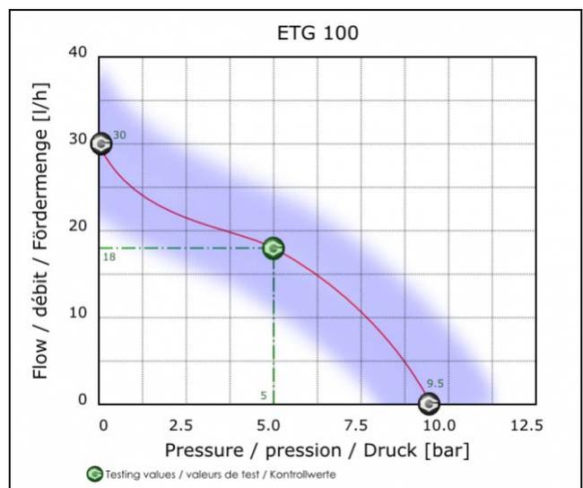
Abb. 61: Leistungsdiagramm der Kondensatpumpe
