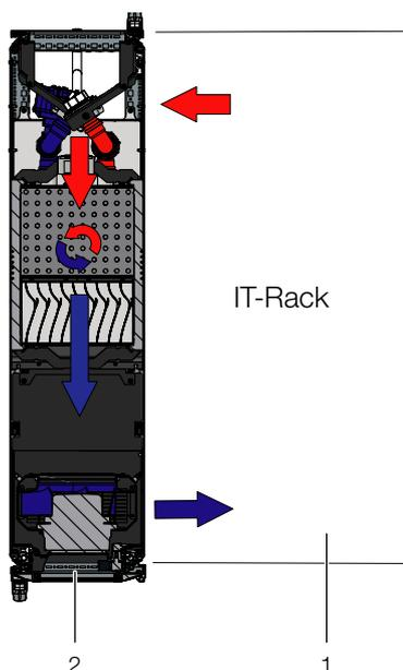
Abb. 79: „Front to Back“-Kühlprinzip mit angereichertem LCP Rack
