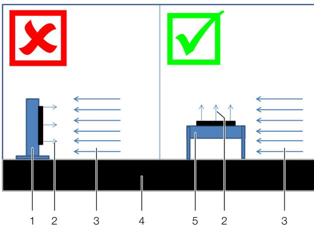
Abb. 16: Luftströmungen bei ungeschützter Aufstellung
