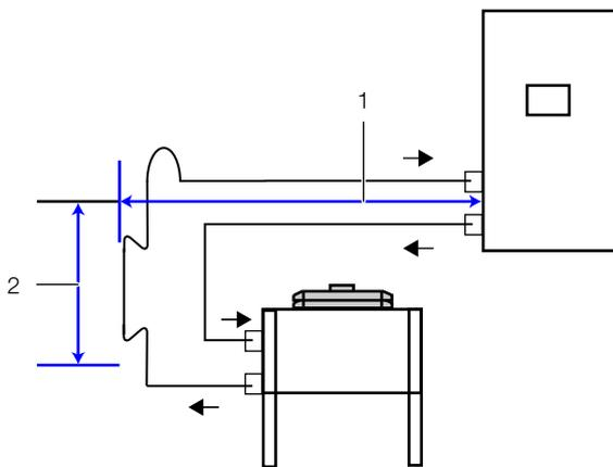
Abb. 11: Relative Positionierung Verflüssiger unterhalb LCP DX
