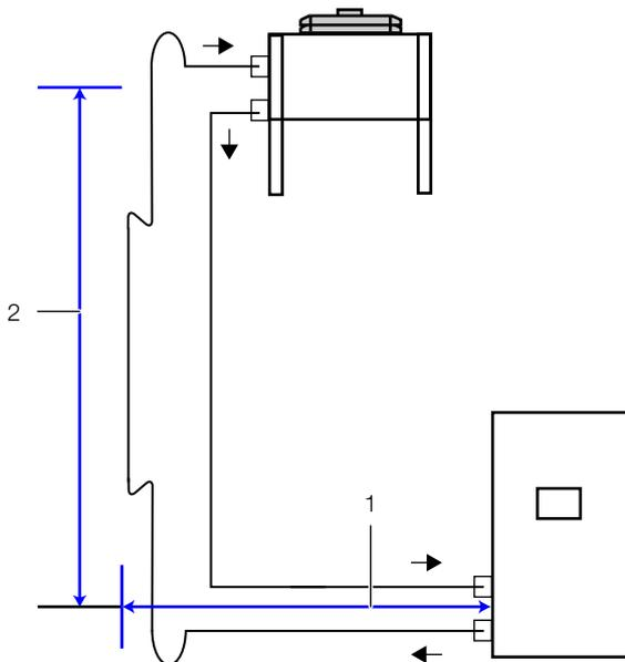
Abb. 12: Relative Positionierung Verflüssiger oberhalb LCP DX
