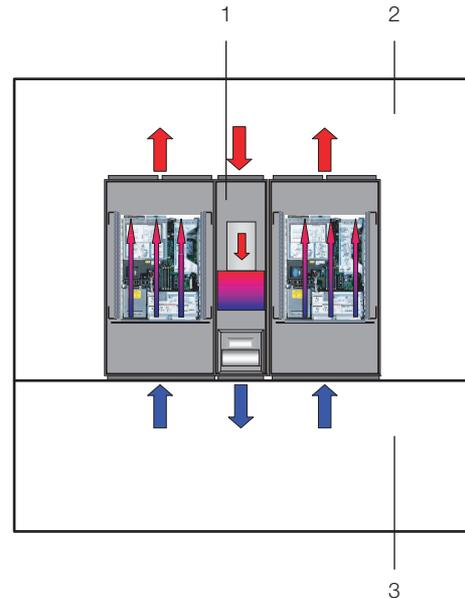
Abb. 13: Aufstellraum mit Kaltgang-Schottung
