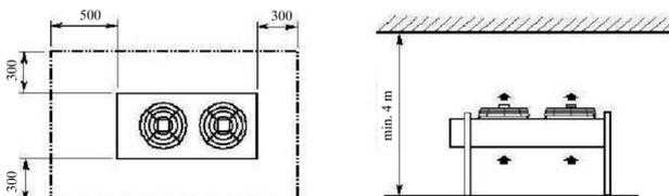
Abb. 17: Minimale Abstände bei vertikaler Montage
