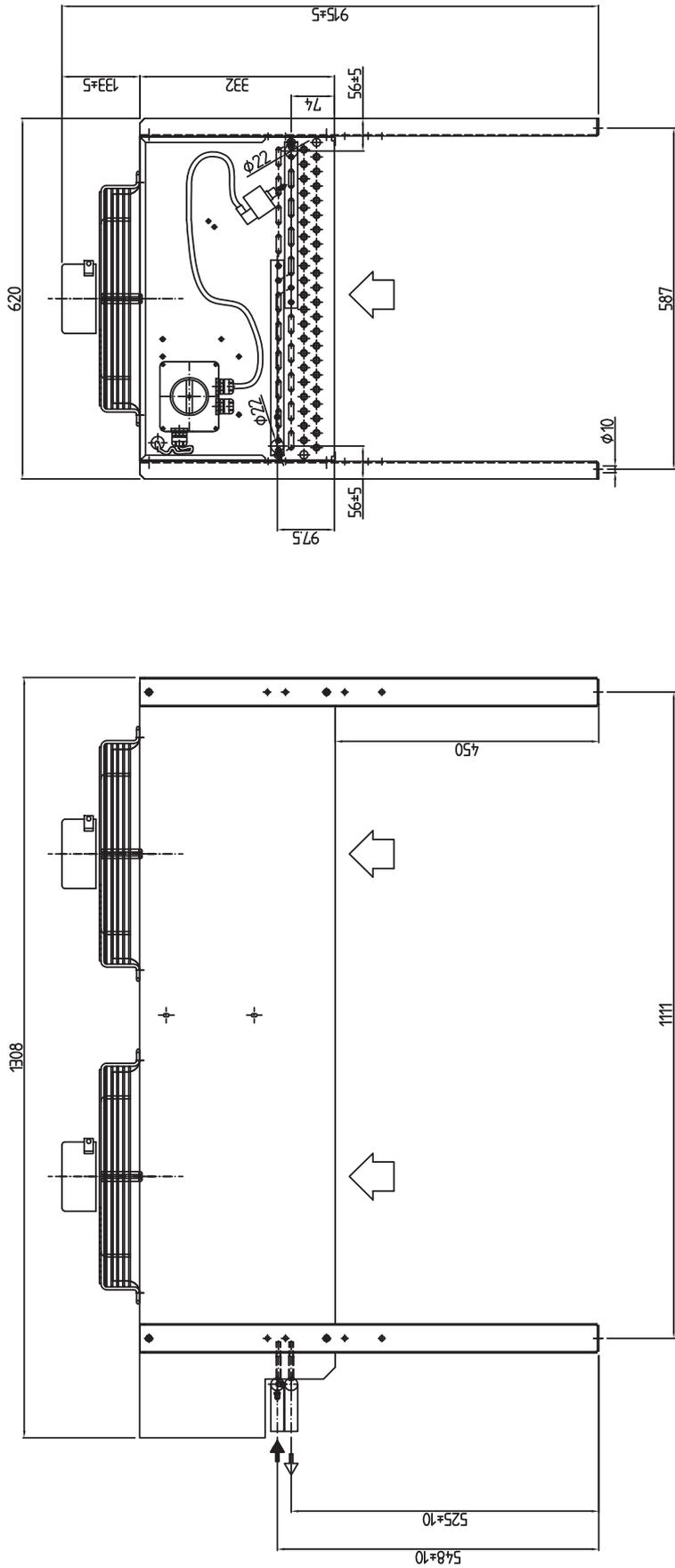
Abb. 70: Standard-Verflüssiger 3311.360 (Pultmontage)
