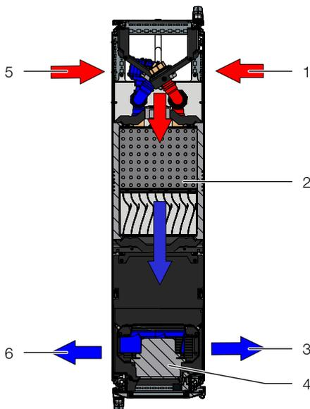
Abb. 1: Luftführung am LCP Rack DX – Draufsicht
