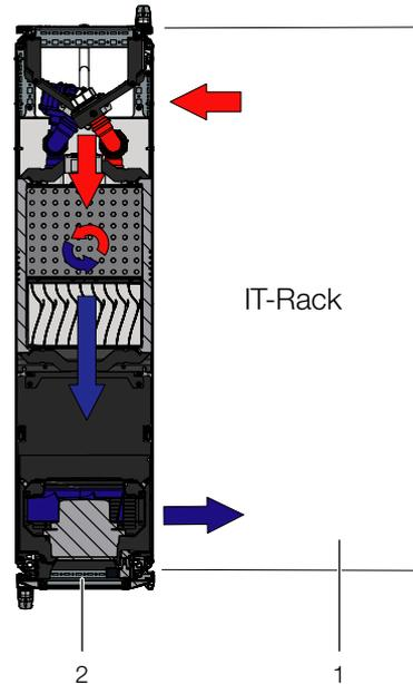
Abb. 4: Luftführung bei einem angereihten Serverschrank – Draufsicht
