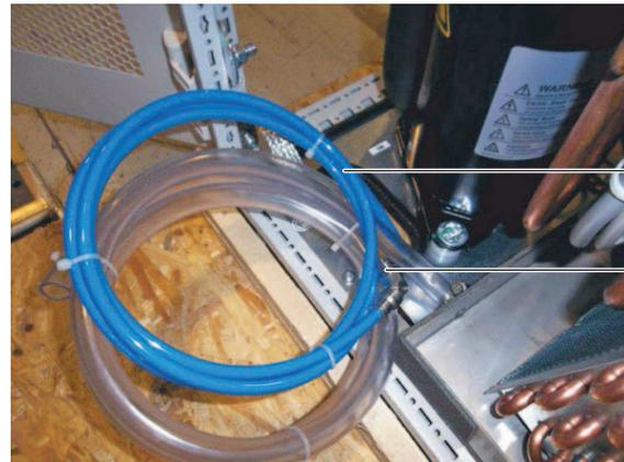
Abb. 53: Anschlusschlauch mit Anschlussstück 1/8" Außengewinde
