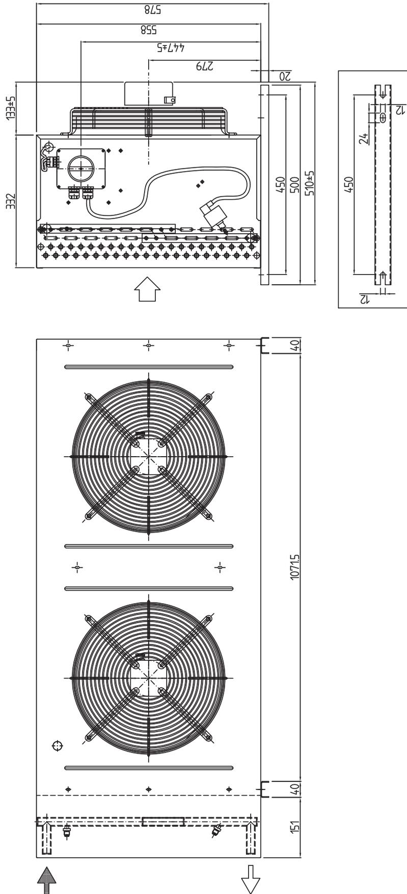
Abb. 71: Standard-Verflüssiger 3311.360 (Fassadenmontage)
