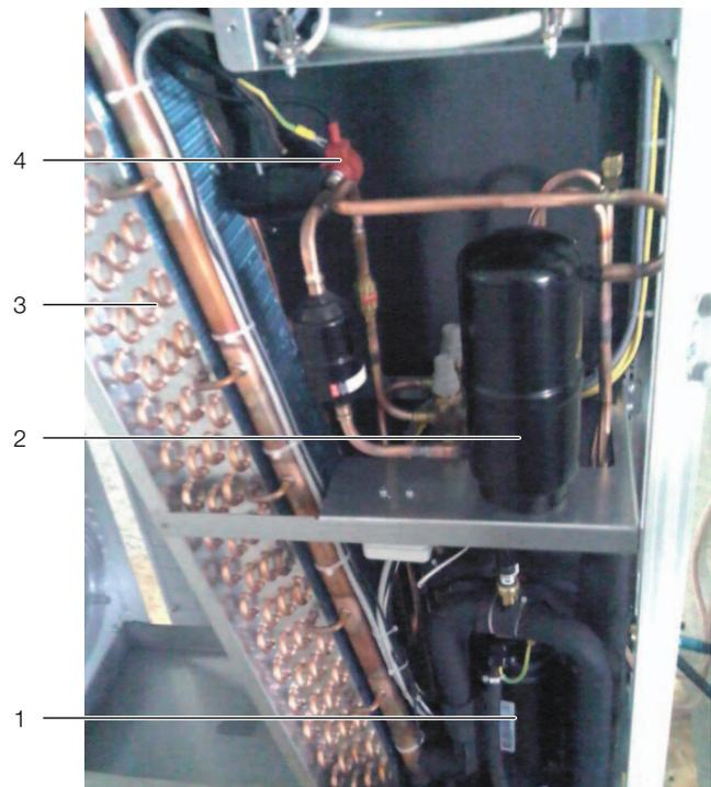
Abb. 9: Kältemittelkreislauf
