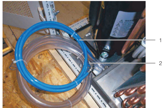
Abb. 51: Anschlusschlauch mit Anschlussstück 1/8" Außengewinde
