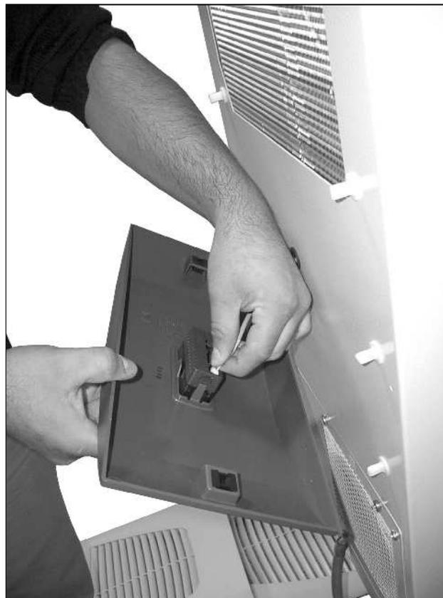
Fig. 42: Estrarre il connettore del display (1)
