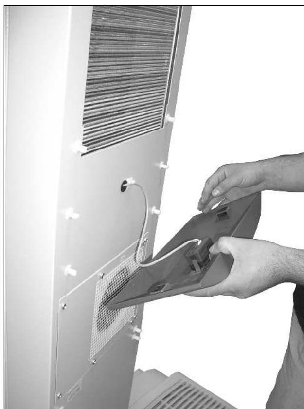
Fig. 63: Asportare la calotta dove è montato il display
