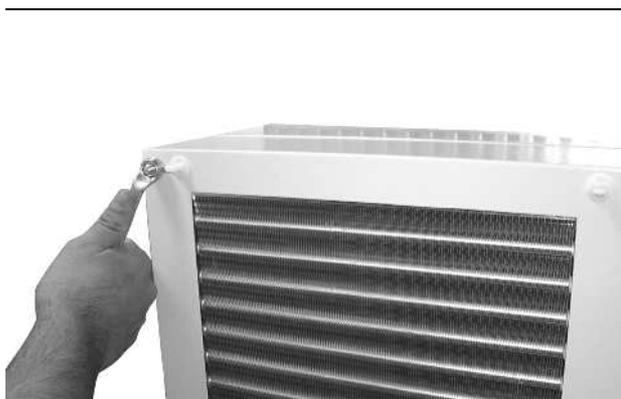
Fig. 48: Smontare il cartor (allontarc i qualtro dadi)
