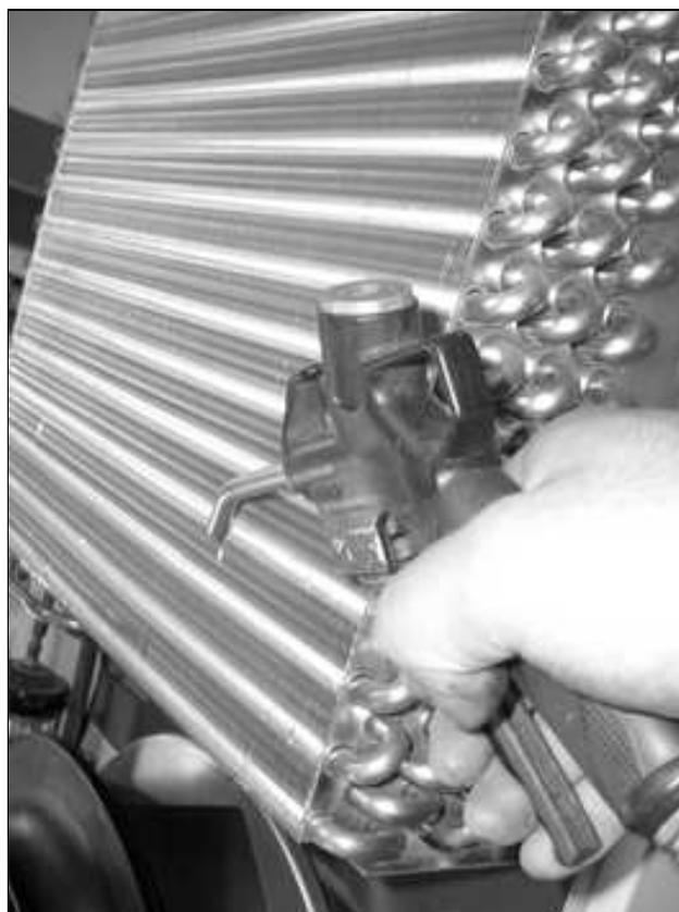
Fig. 55: Soffiare aria compressa sui tubi dello scambiatore di calore e nel vano compressore (1)
