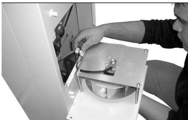
Fig. 69: Staccare i connettori del ventilatore (1)
