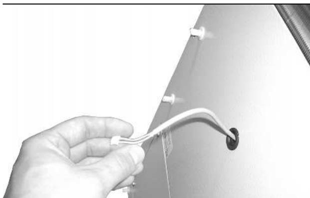
Fig. 49: Fare arretrare il cavo del display
