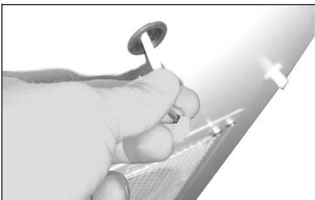
Fig. 65: Fare arretrare il cavo del display nel foro di passaggio dei cavi (1)
