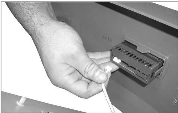
Fig. 64: Fare arretrare il cavo del display
