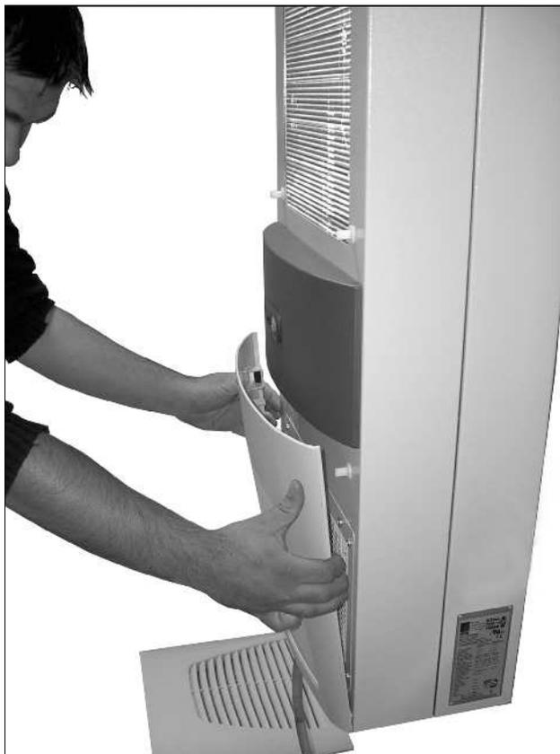
Fig. 40: Asportare la griglia di aerazione inferiore
