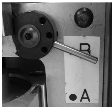
Fig. 11 : réglage de l'unité de fixation du fil toronné (réglé : B)
