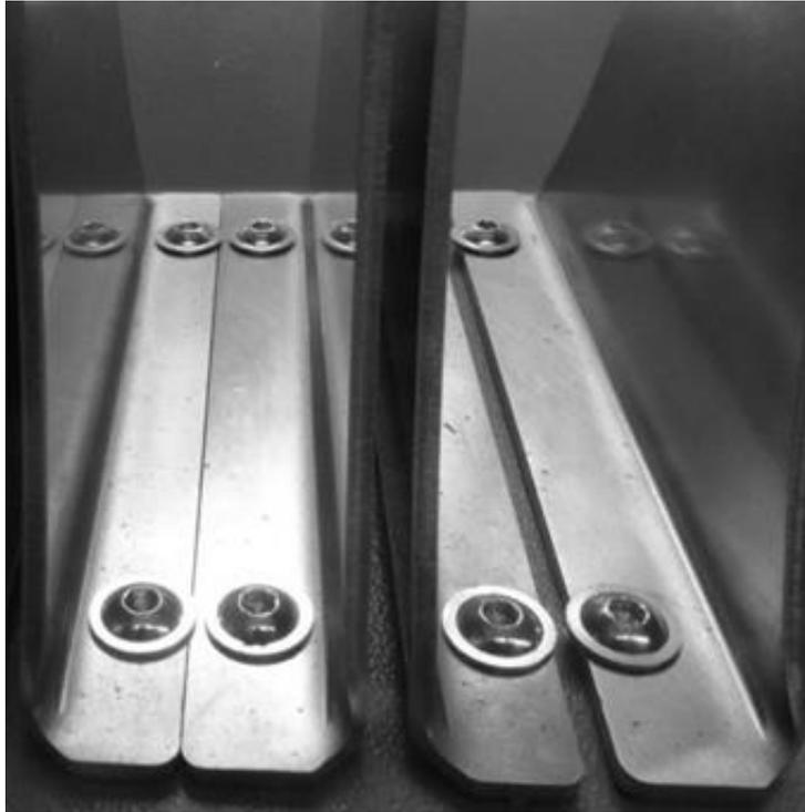
Abb. 7: Rollenhalter (Länge 8 mm: links, Länge 10 mm: rechts)
