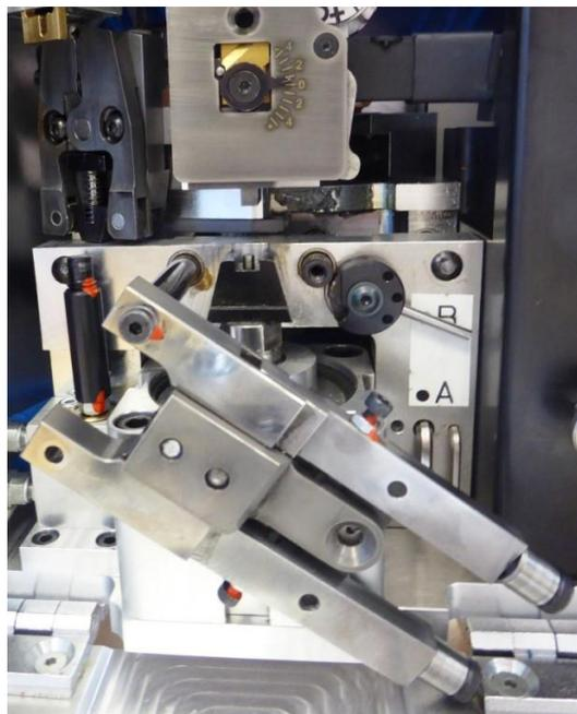
Abb. 13: Litzenfixiereinheit demontiert
