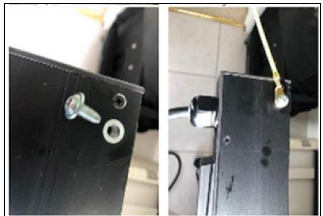
Abb. 15: Gehäuse-Erdungspunkt
