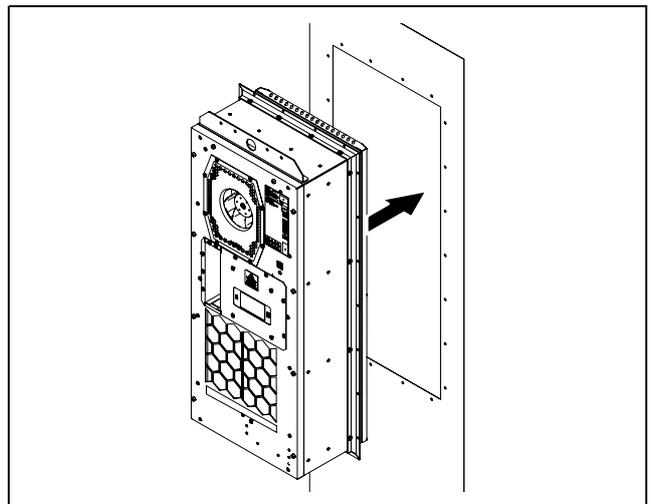
Abb. 25: Einsetzen des Kühlgeräts in ein einwandiges Flachteil
