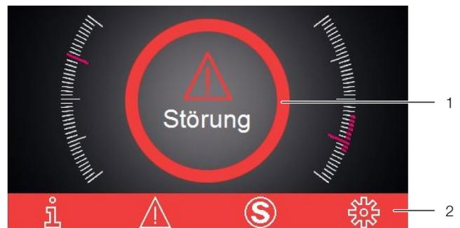
Abb. 44: Bildschirm bei Auftreten einer Störung
