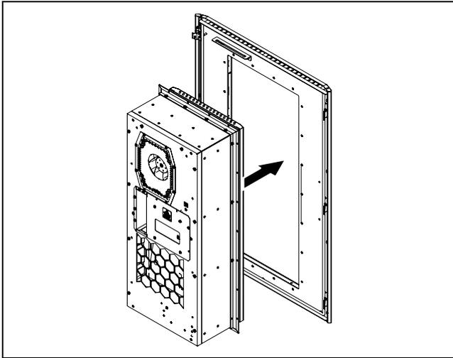
Abb. 26: Einsetzen des Kühlgeräts in ein doppelwandiges Flachteil
