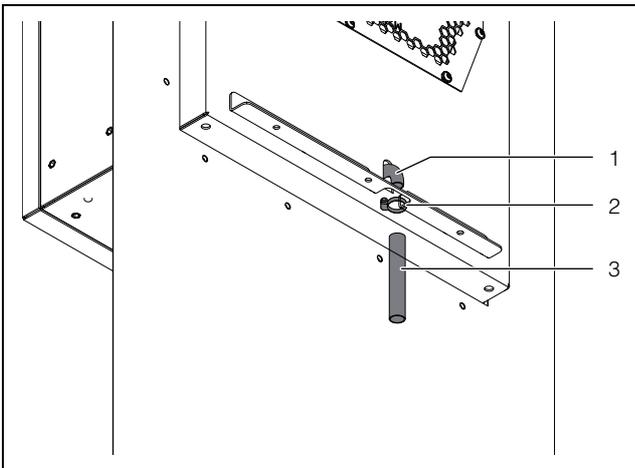
Abb. 30: Anschluss für Kondensatwasserablaufschlauch
