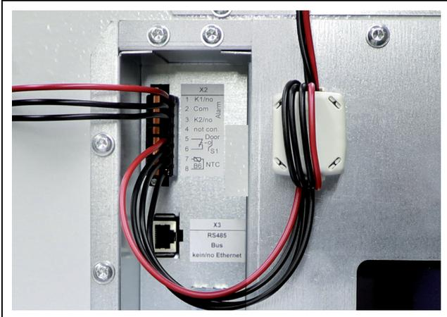
Abb. 32: Montagepunkt des Ferritkerns bei SK 3185330
