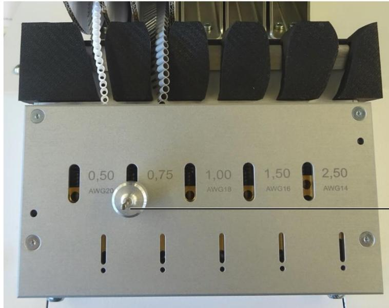
Fig. 10: Perno di fissaggio superiore
