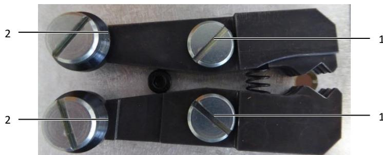
Fig. 22: Tenaglie di bloccaggio del filo
