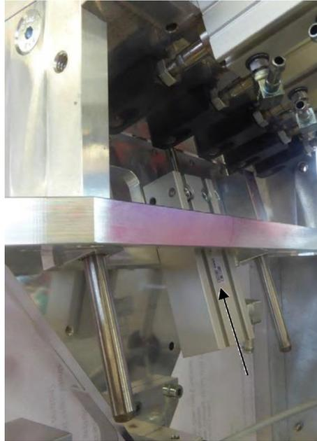
Fig. 32: Cilindro della lama di separazione dei puntalini
