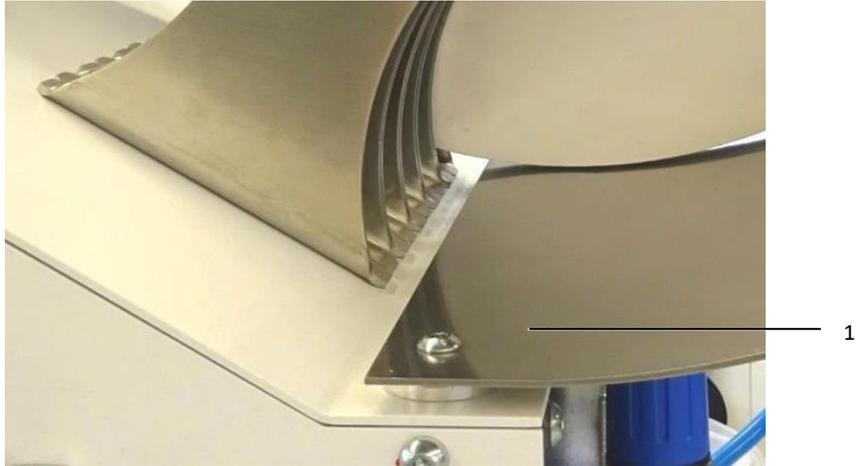
Fig. 5: Piastra di tenuta montata
