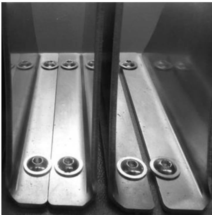
Fig. 7: Porta-bobina (lunghezza 8 mm: sinistra, lunghezza 10 mm: destra)
