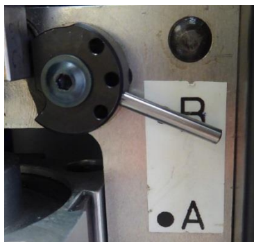
Fig. 13: Indstilling af trådfikseringsenhed (indstilling: B)
