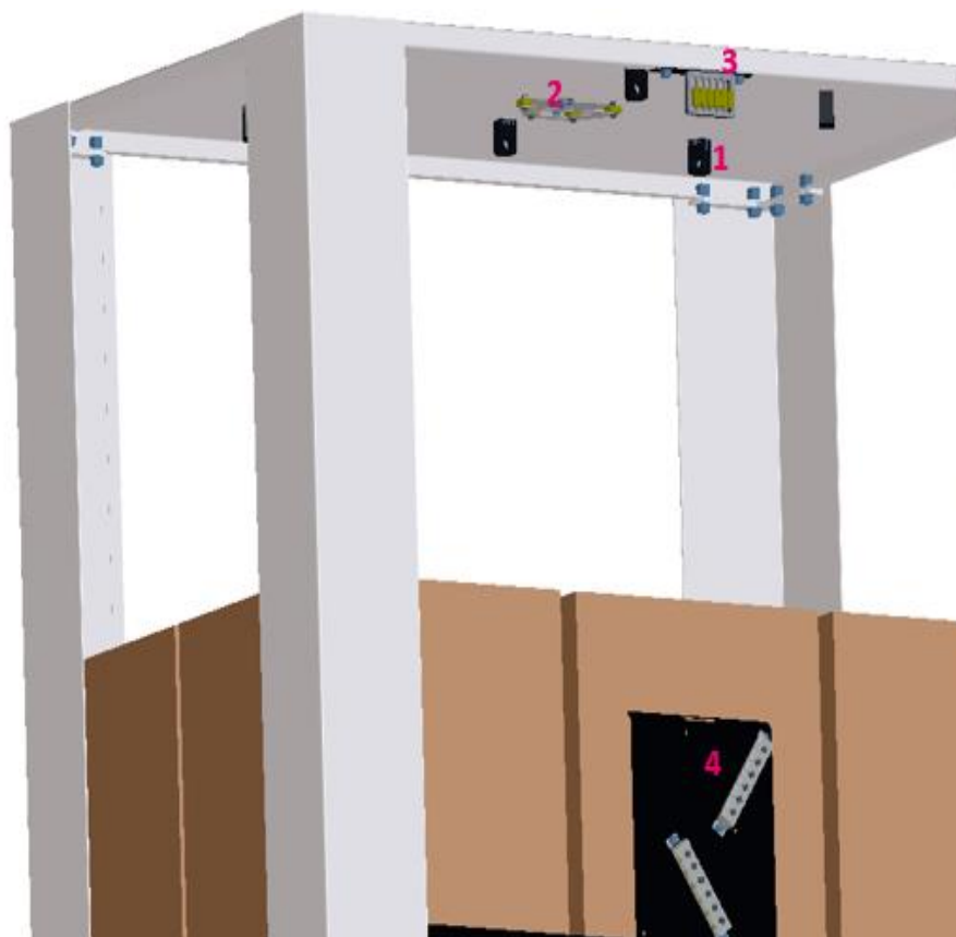
Obr. 8: Zavedení vodičů do kladek v horní části regalu
