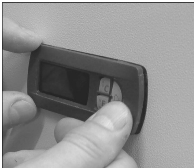
図 12: パネルの取付け
