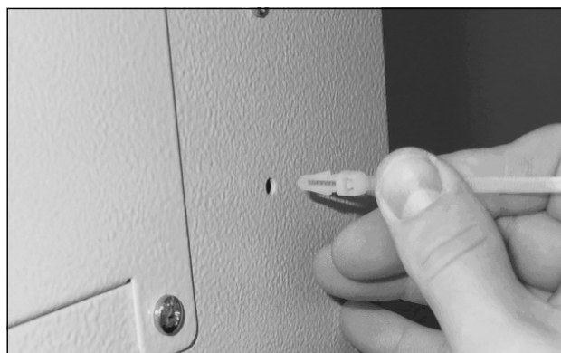
図 18: 張力除去用のクリップ式ケーブルタイを温度管理モジュールの前半分部分に取付ける
