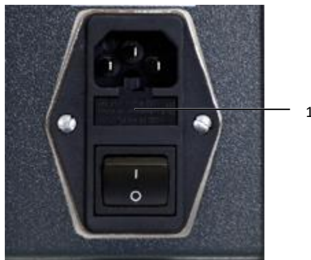
Fig. 19 : ouvrir le logement du fusible
