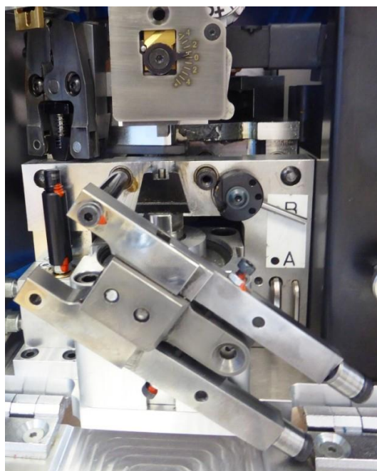
Fig. 13 : unité de fixation du fil toronné démontée
