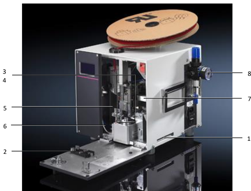
Fig. 9: vue d'ensemble des points d'entretien
