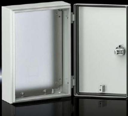
Statt den serienmäßig beigefügten Doppelbart-Vorreiber-Verschlüssen können Kunststoff-Handgriffe 2577.010 mit einer Volkswagen E1-Schließung montiert werden. Dem Kunststoff-Handgriff 2577.010 sind zwei verschiedene Schließnasen beigelegt um den Einsatz sowohl für Kompakt-Schaltschränke der Baureihe AX als auch für E-Boxen der Baureihe KX-EB zu ermöglichen. Für E-Boxen der Baureihe KX-EB ist die kleinere Schließnase zu verwenden.
