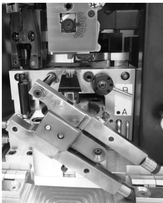
图例 20: 已拆卸绞合线固定单元
