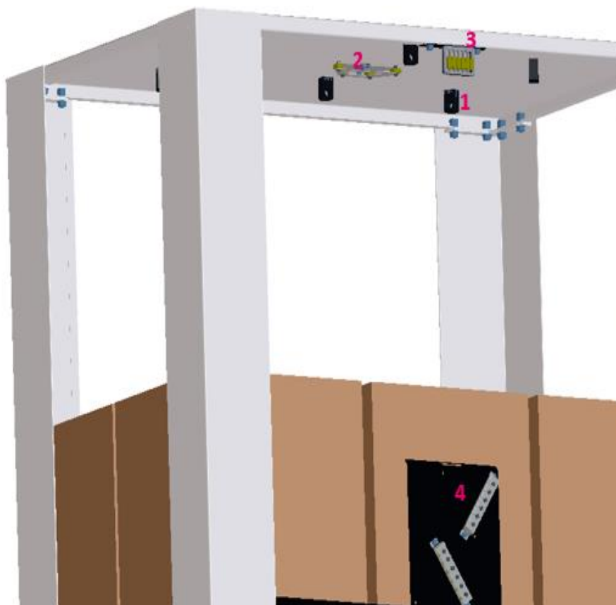
Fig. 8: Ledningsindføring fra ekstramodulets øverste niveau
