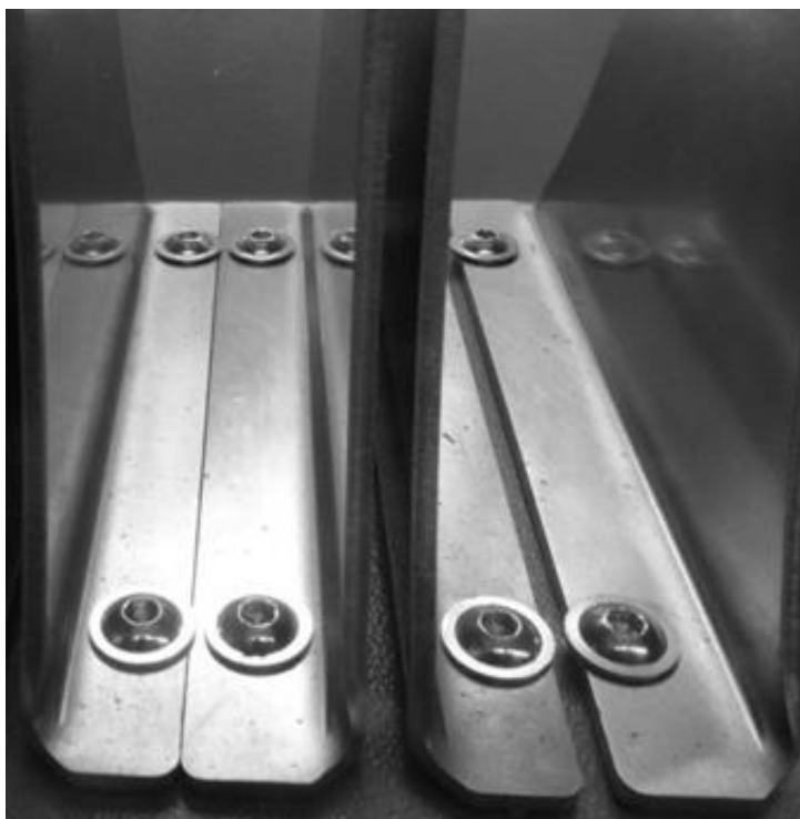
Obr. 7: Držák kotoučů (délka 8 mm: vlevo, délka 10 mm: vpravo)
