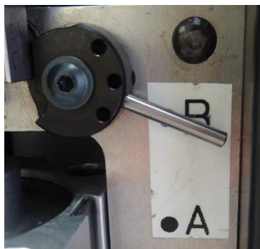
Obr. 13: Nastavení jednotky pro fixaci lanek vodiče (nastaveno: B)
