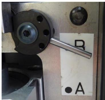
Imagen 13: Ajuste unidad de fijación del trenzado (ajustado en B)
