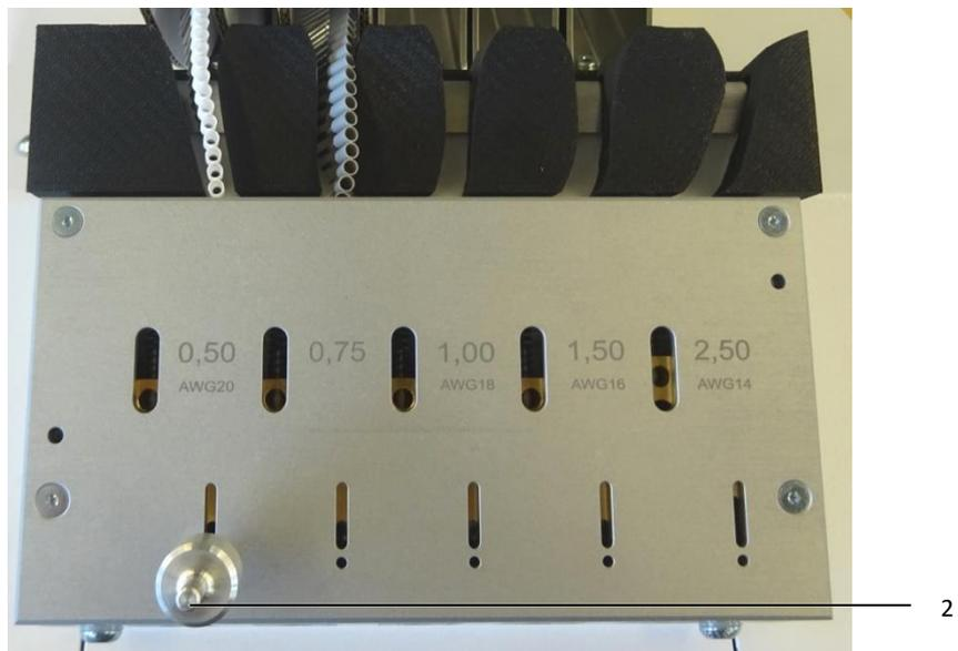
Imagen 9: Espiga de fijación abajo
