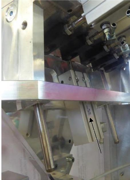
Imagen 32: Cilindro de la cuchilla para cortar manguitos
