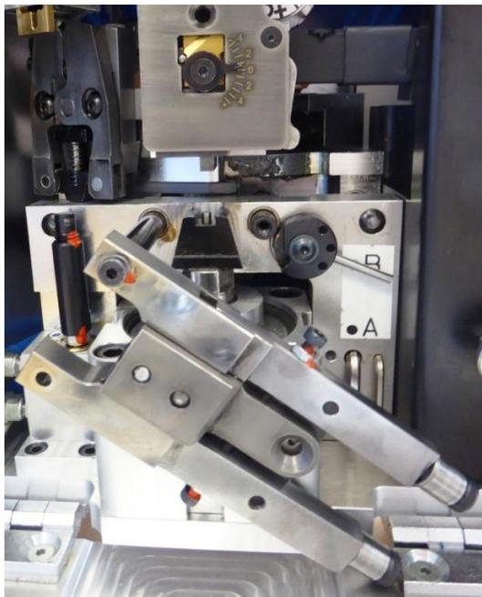
Imagen 25: Unidad de fijación del trenzado desmontada
