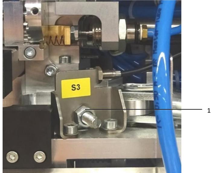
Imagen 34: Fijación de la unidad de soporte de manguitos
