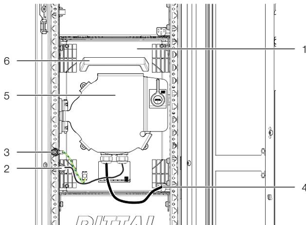
Fig. 16: Fan module in fan tray
