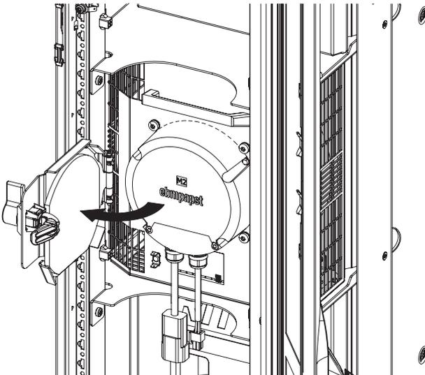
Fig. 46: Opening the fan door
