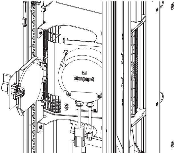
Fig. 53: Pushing in the fan module
