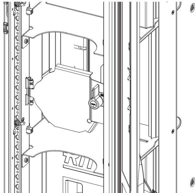
Fig. 52: Placing the fan door
