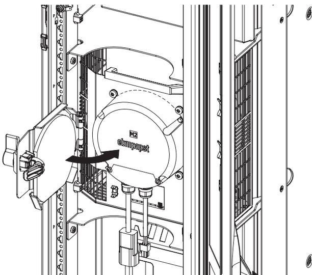
Fig. 54: Closing the fan door
