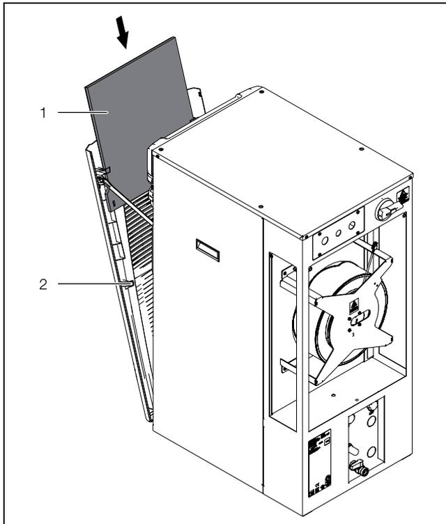
Fig. 36 : insertion de la cartouche filtrante
