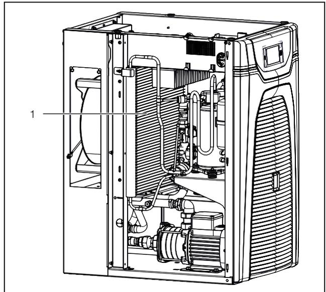
Fig. 48 : nettoyage du condenseur (modèle représenté : 3334300)
