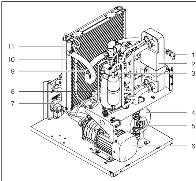
Fig. 16 : composants intégrés dans le refroidisseur d'eau
