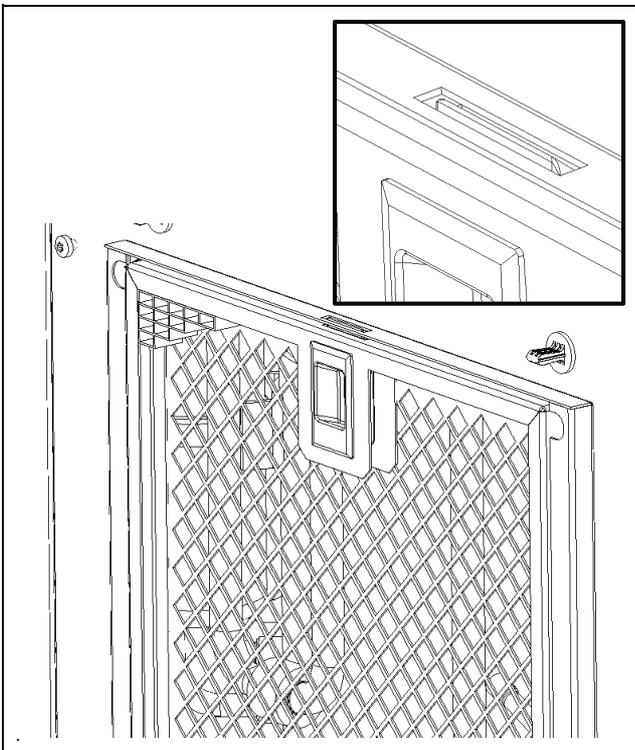
Fig. 34 : mise en place d'un filtre métallique 3320200 et 3334300
