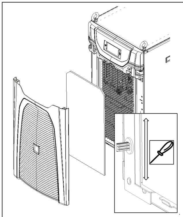
Fig. 32 : installation d'une cartouche filtrante textile 3320200 et 3334300
