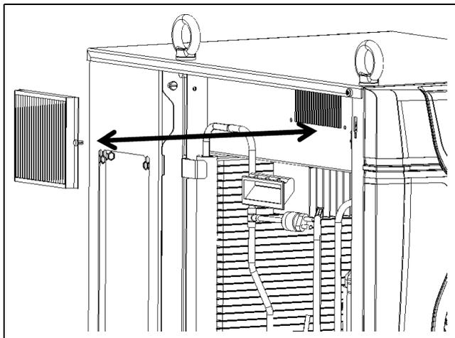
Fig. 37 : mise en place d'un filtre plissé
