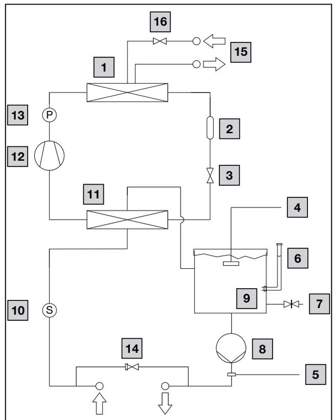
Fig. 21 : principe de fonctionnement du circuit frigorifique avec condenseur refroidi à l'eau
