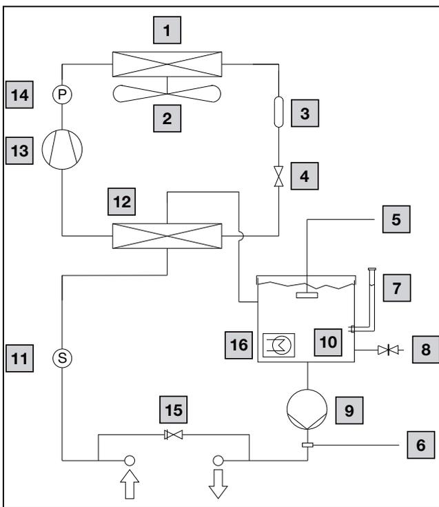
Fig. 22 : principe de fonctionnement du circuit frigorifique avec chauffage de la cuve
