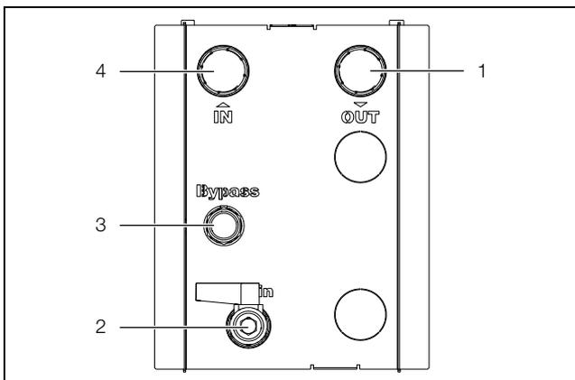
Fig. 6 : raccords et organes de signalisation de l'appareil
