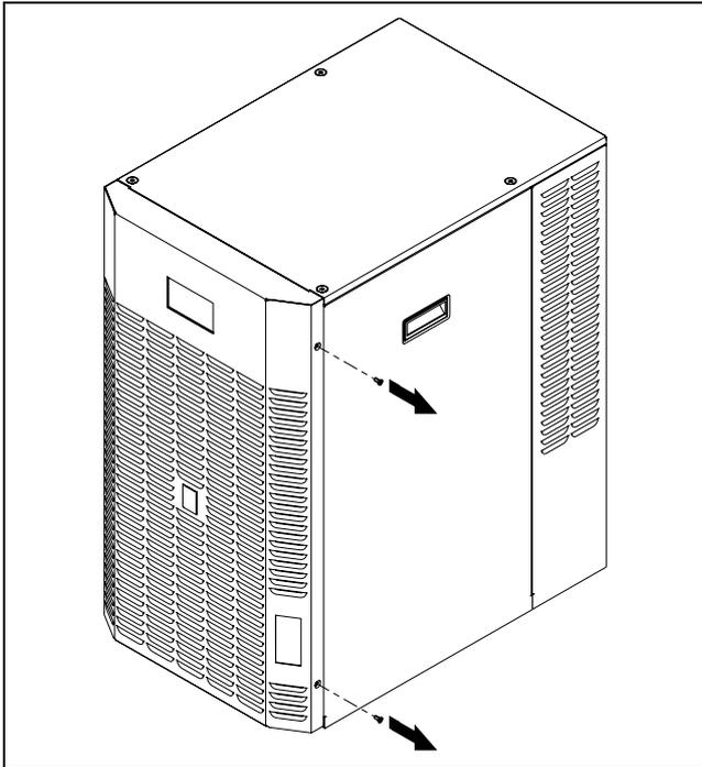
Fig. 11 : enlèvement des vis de sécurité
