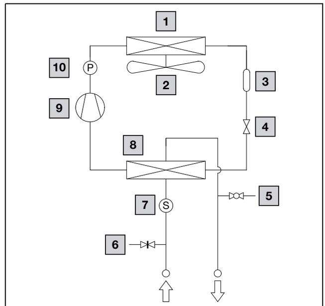
Fig. 15 : principe de fonctionnement du circuit frigorifique et du circuit hydraulique « huile/émulsion »
