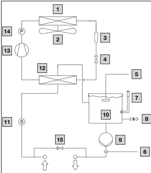
Fig. 7 : schéma fonctionnel du circuit frigorifique
