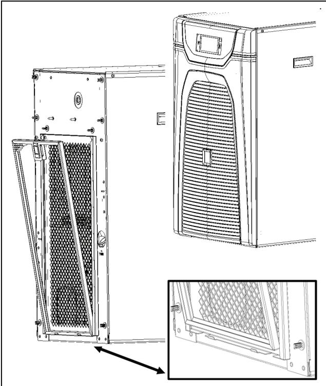
Fig. 33 : installation d'un filtre métallique 3320200 et 3334300
