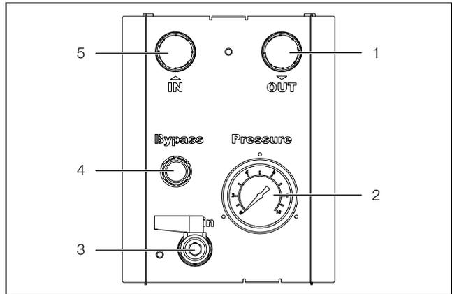
Fig. 17 : raccords et organes de signalisation de l'appareil
