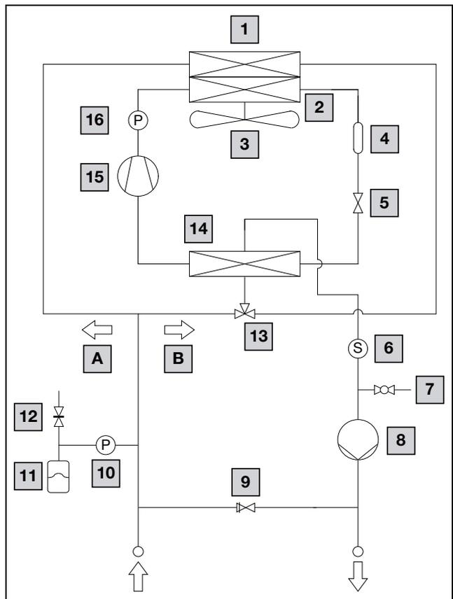
Fig. 18 : principe de fonctionnement du circuit frigorifique avec l'option « Free Cooling »
