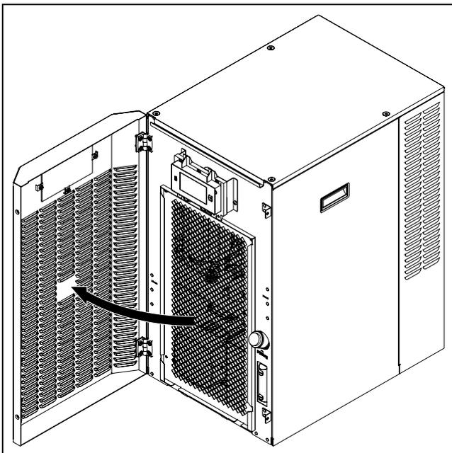
Fig. 12 : ouverture de la face avant
