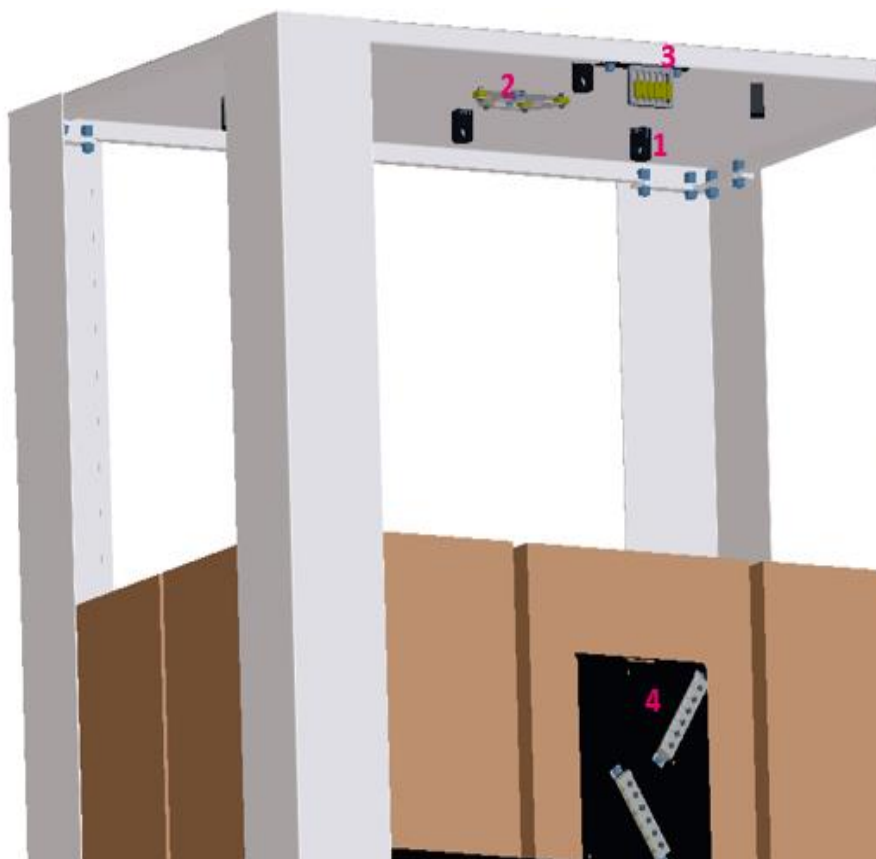
Fig. 8: Introducción del cable en el nivel superior del módulo adicional
