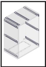
**12. Montage Schiene für Innenausbau in AX Edelstahl**
