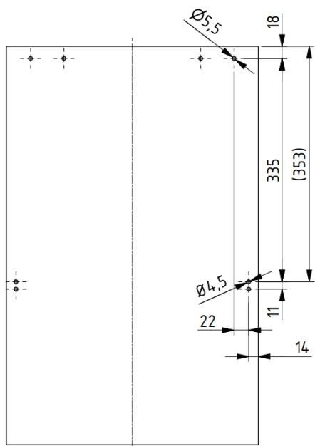
Bohrung Ø 5,5: Bohrbild für Gehäusescharnier
