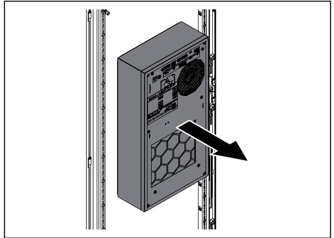
Fig. 58 : extraction du climatiseur de la découpe de montage
