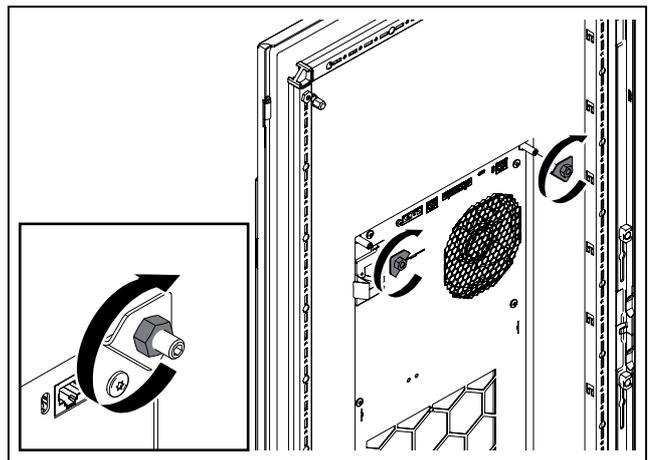
Fig. 17 : bloquer les équerres d'angle en haut
