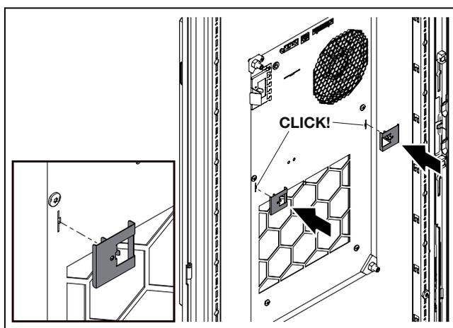
Fig. 19 : blocage des crampons de fixation
