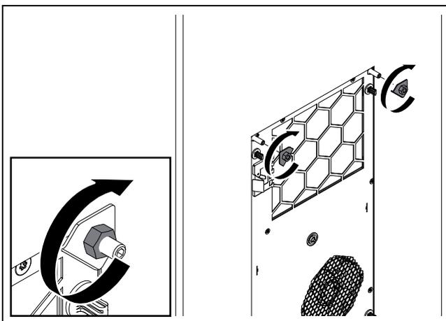
Fig. 37 : bloquer les équerres d'angle en haut
