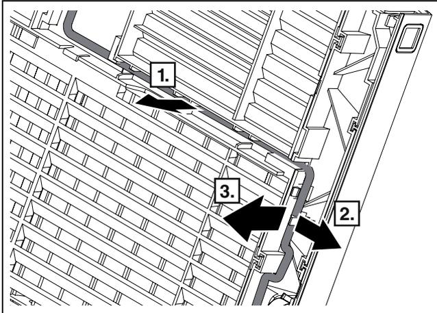
Fig. 25 : enlèvement du câble de raccordement
