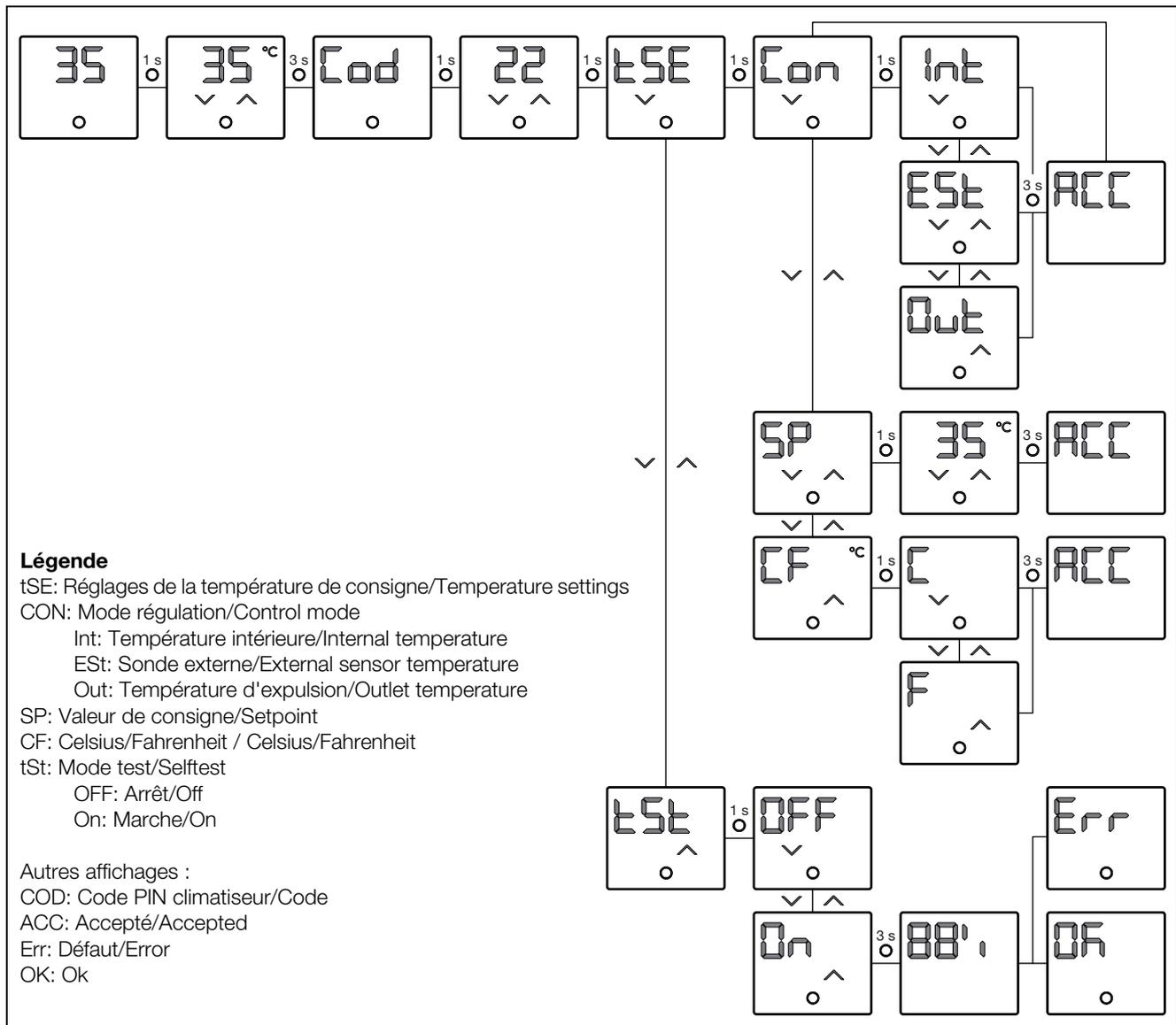
Fig. 54 : tableau synoptique de la programmation
