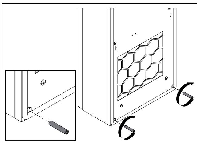
Fig. 10 : vissage des tiges filetées inférieures
