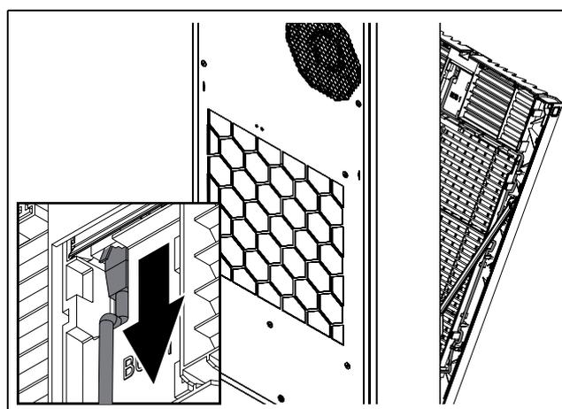
Fig. 24 : débranchement de la fiche de raccordement
