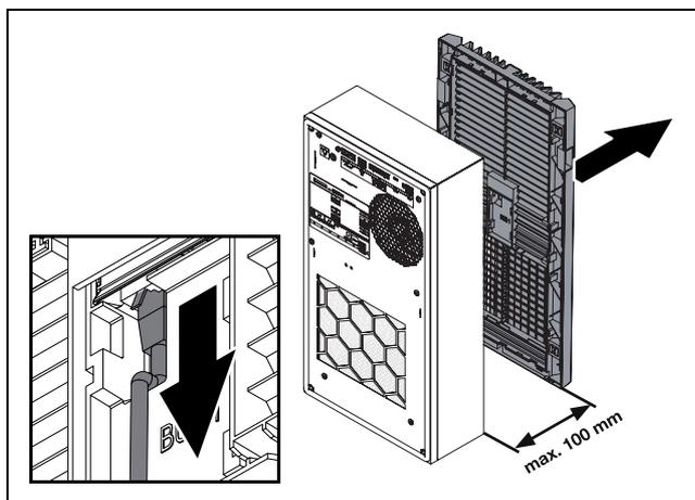
Fig. 21 : enlèvement de la grille à lamelles et de la fiche de raccordement
