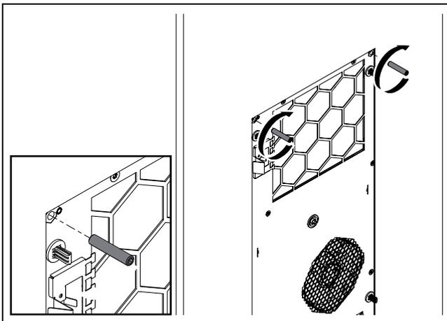
Fig. 36 : vissage des tiges filetées supérieures
