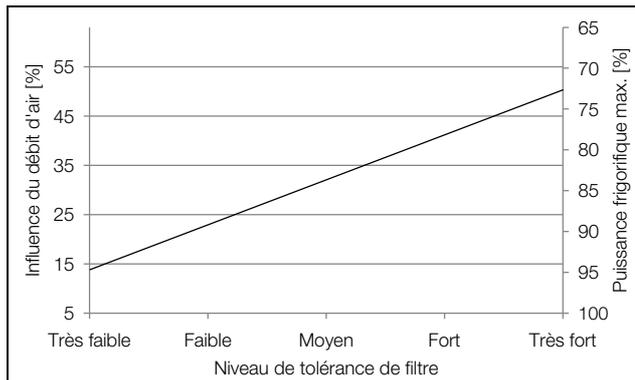
Fig. 55 : exemple de tracé de la puissance frigorifique
