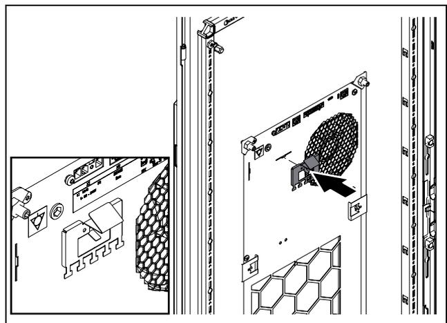
Fig. 49 : pince d'accrochage pour le guidage des câbles
