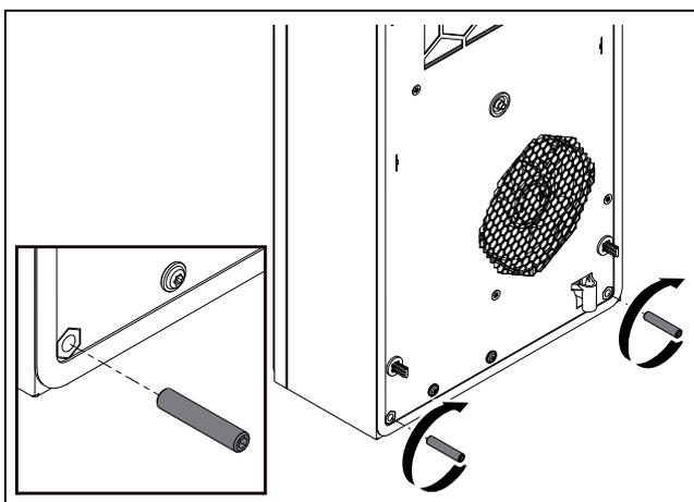
Fig. 32 : vissage des tiges filetées inférieures
