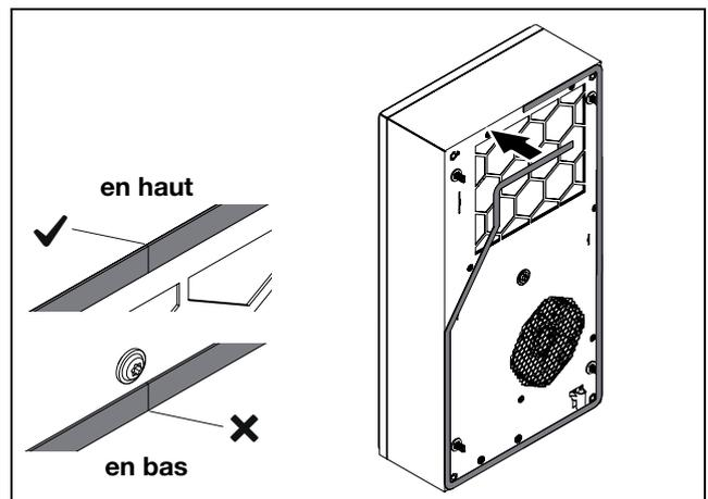
Fig. 29 : positionnement du raccord en haut
