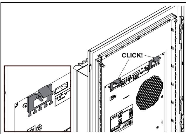
Fig. 15 : enclenchement des pinces à l'arrière de la découpe (pour les références SK 31848x0)
