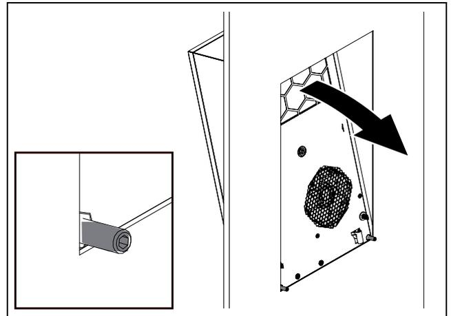
Fig. 33 : mise en place et insertion du climatiseur
