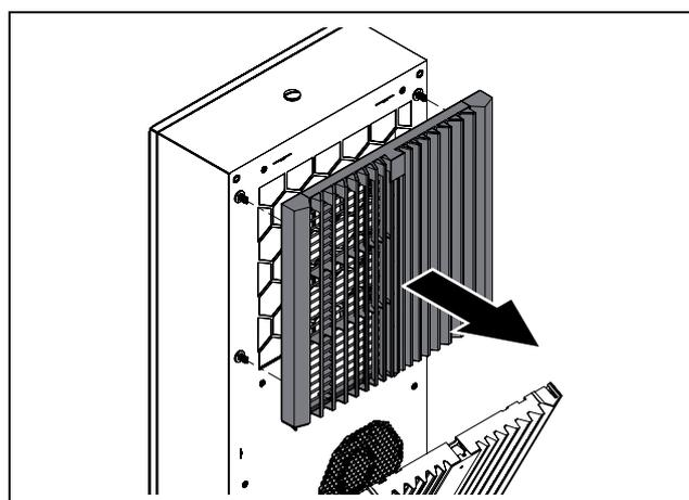
Fig. 23 : enlèvement de la grille à lamelles supérieure
