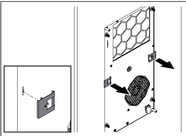
Fig. 57 : enlèvement des crampons de fixation
