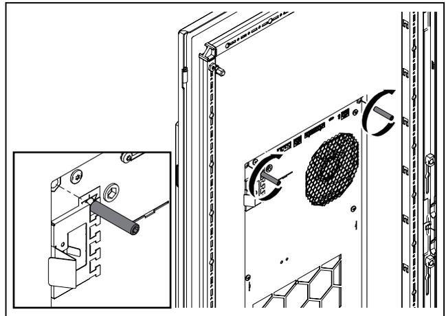
Fig. 16 : vissage des tiges filetées supérieures
