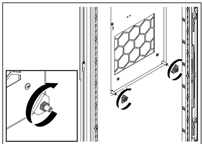
Fig. 18 : bloquer les équerres d'angle en bas
