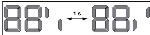
Fig. 53 : évolution du pourcentage de réalisation du test
