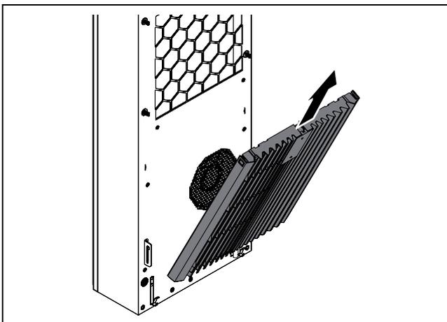
Fig. 27 : enlèvement de la grille à lamelles inférieure
