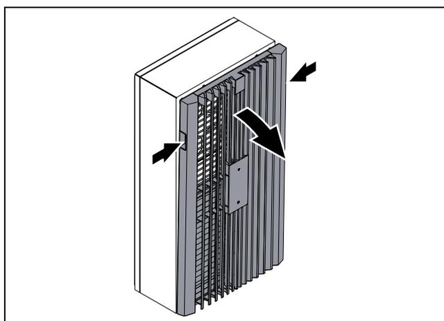
Fig. 20 : enlèvement de la grille à lamelles (par le haut)
