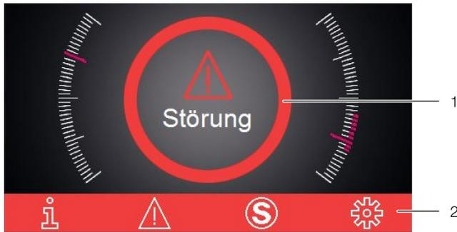
Fig. 44 : écran lors de l'apparition d'un incident
