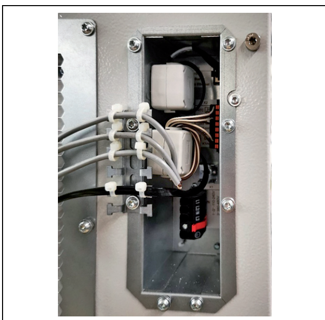
Imagen 33: Punto de montaje del núcleo de ferrita en SK 3186330, SK 3187330, SK 3188340, SK 3189340
