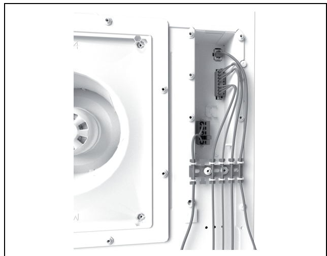
Imagen 40: Realización del ajuste de tracción con bridas (imagen de ejemplo)
