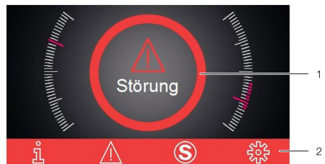
Abb. 19: Bildschirm bei Auftreten einer Störung
