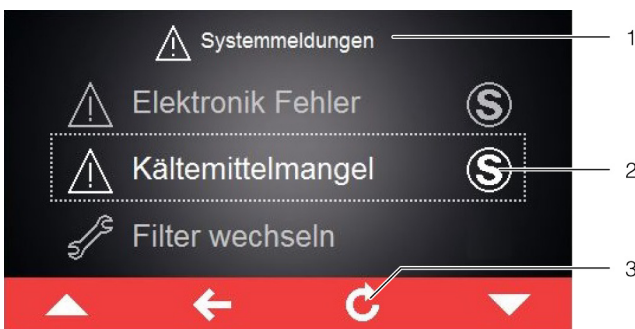
Abb. 21: Bildschirm mit Fehlermeldungen
