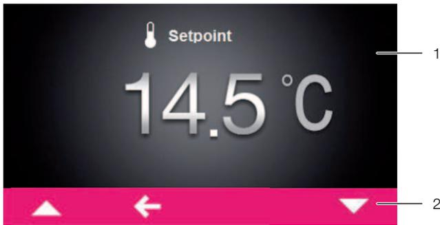
Abb. 28: Bildschirm zum Ändern eines Parameterwerts
