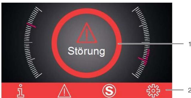
Abb. 32: Bildschirm bei Auftreten einer Störung
