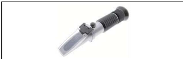
Fig. 22: Rifrattometro
