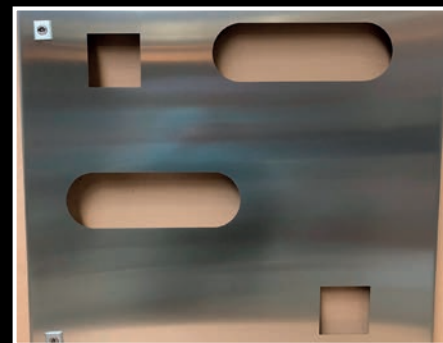
Výřezy do rozváděčových skříní
