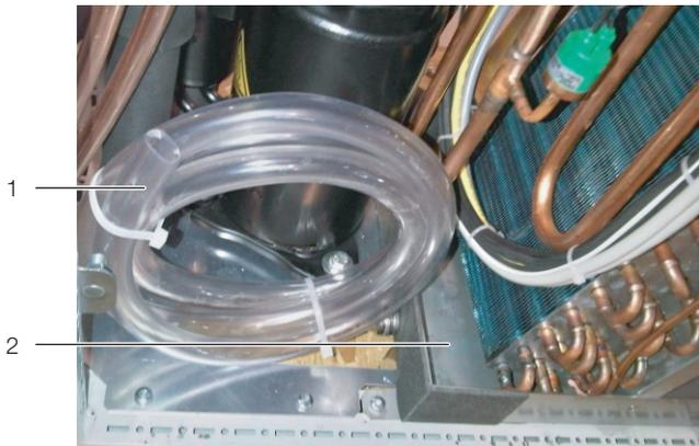
Fig. 23 : évacuation des condensats
