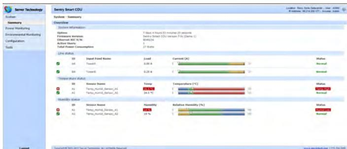
Web、SNMP、Telnet など、標準ネットワーク管理インターフェイスにより、PDU の電流値、オプションの温湿度の監視、管理が遠隔から可能になります。事前に設定された使用電流値や温度などの閾値を超えた場合のアラート通知を電子メールや SNMP で指定した IT 管理者に通知することができます。
