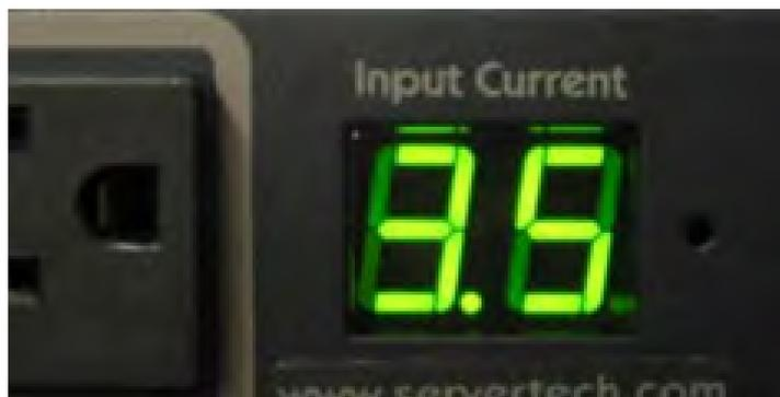
PDU 本体に使用電流値を確認できるディスプレイを搭載。
