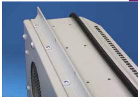
Вдавить уплотнение в монтажную раму. Благодаря предварительной смазке снижается трение между уплотнением и корпусом. Кроме того, повышается плотность прилегания уплотнения. В смонтированном состоянии такое уплотнение является оптимальным.
