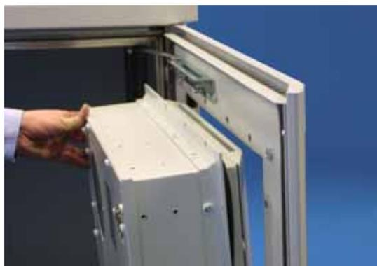
Отвинтите винты по периметру крепежной рамы. Затем переместите крепежную раму в новое положение и закрепите ее винтами. Во время работ агрегат не следует класть на декоративный кожух.
