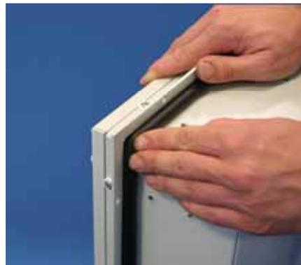
Установить агрегат в вырез двери. Сначала наживить крепежные винты, затем затянуть их в "крестообразной" последовательности. Контакт заземления холодильного агрегата подсоединяется с помощью контактной шайбы.
