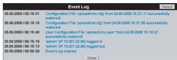
Рис. 89: Сообщения об успешной перезаписи файла конфигурации
