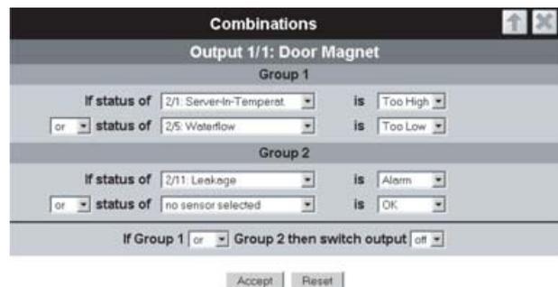
Рис. 88: Экран настроек для выхода "Door Magnet"
