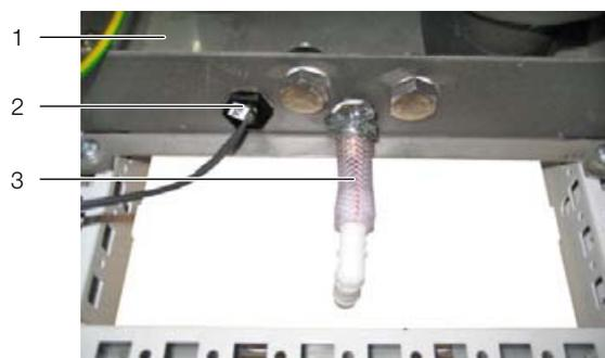
Рис. 41: Отвод конденсата
