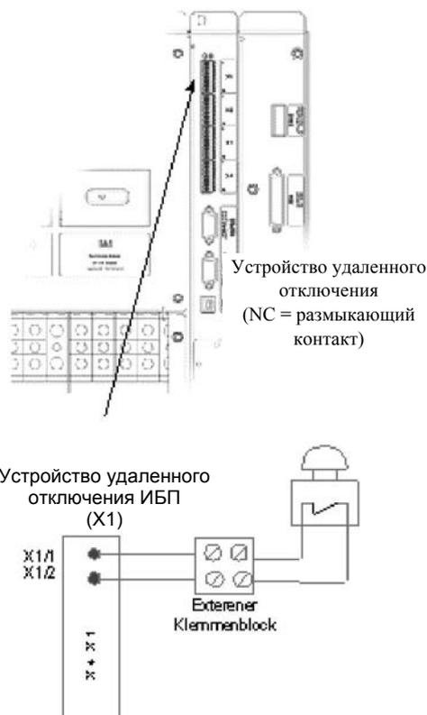
Рис. 29: Подключение устройства удаленного отключения
