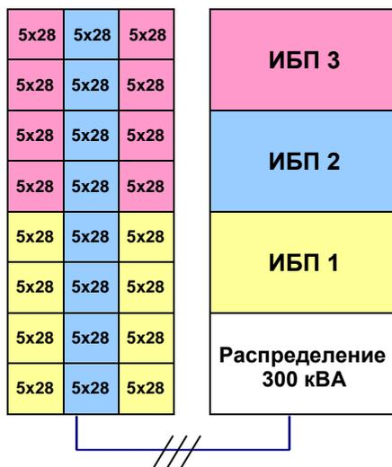
Рис. 3.6 Пример: в один внешний шкаф для батарей СВАТ-М может быть установлено до (3x40) x 28 Ач общих комплектов батарей. При необходимости предоставляется конфигурация с отдельными батареями, если для каждого модуля ИБП используется отдельный комплект, как, например: 40 x 28 Ач.
