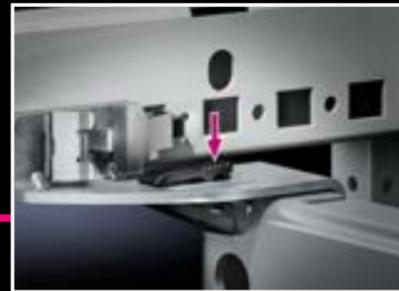
Изменение без инструментов глубины установки монтажной панели благодаря простому креплению на защелках. Крепление испытано на нагрузки при транспортировке. При необходимости можно использовать предыдущий вариант крепления на винтах. Монтажная панель просто устанавливается спереди и дополнительно удерживается опускающимися фиксаторами.
