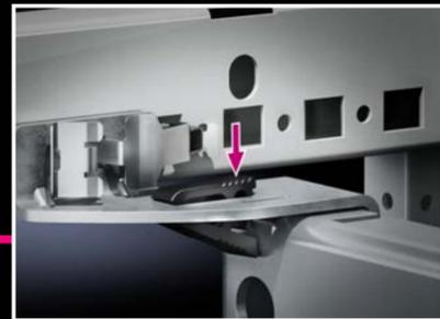
Werkzeuglose Montageplatten-Tiefenverstellung durch einfache Clip-Befestigung. Transport-Schwingungsprüfung bestanden. Kann bei Bedarf wie bisher verschraubt werden. Montageplatte einfach von vorne einsetzen und durch Clip fixieren.
