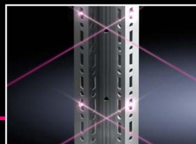
Zusätzliche Markierung im Vertikalprofil alle 100 mm zur einfachen Orientierung/Positionierung. Befestigung mit M8 selbstformenden Schrauben ohne Vorbohren möglich.
