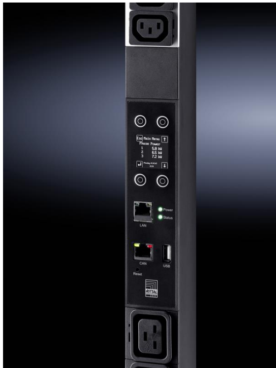
Abbildung 7: Rittal nutzt OLED-Technologie um den Energieverbrauch zu senken.
