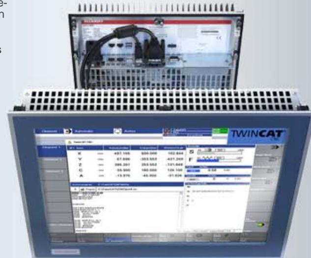
Bei den Industrie-PCs der Serie C65xx wird der Kühlkörper durch einen passenden Ausschnitt in der Schaltschrankwand nach außen geführt. Integrierte Dichtungen sorgen für die wasser- und staubdichte IP-67-Ausführung.
