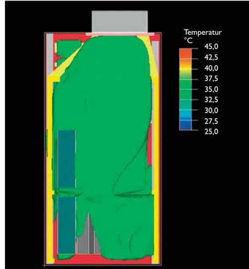
Abb. 43: Isotherme 35 °C (Bereiche gleicher Temperatur)
