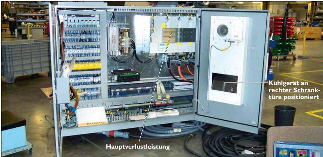
Abb. 46: Praxisbeispiel einer Kühlgerätepositionierung: Die Kühlluft wird an der Stelle bereitgestellt, an der die größte Verlustleistung anfällt. Oberhalb des Umrichterverbands steht allerdings kein ausreichender Freiraum zur Verfügung.
