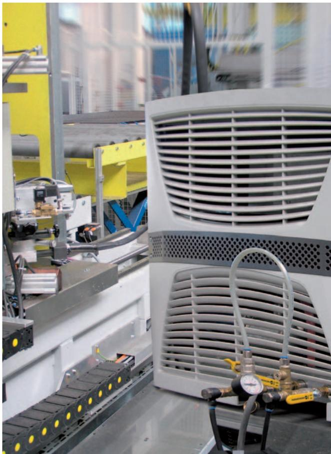
Rückkühlanlagen sorgen für eine zentrale und wirtschaftliche Abkühlung und Bereitstellung des Kühlmediums (in der Regel Wasser-Glykol-Gemisch). Über ein Rohrleitungssystem können alle Kühlaufgaben an einer Anlage oder Maschine sowie im Schaltschrank gelöst werden.
