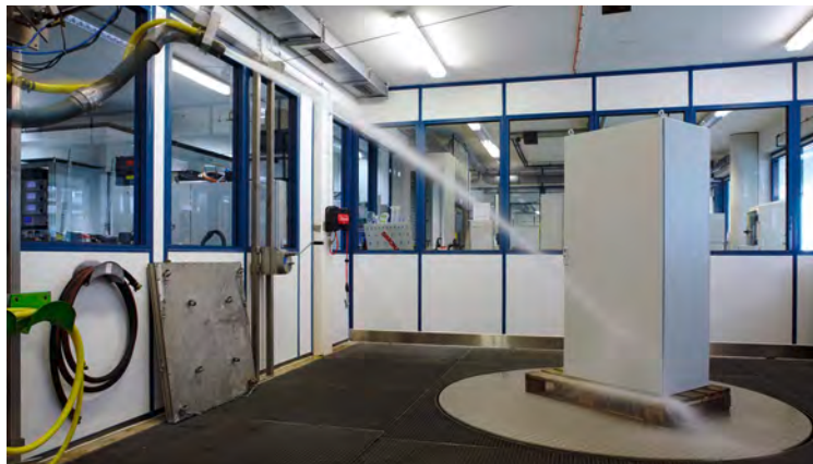
Test IP w laboratorium badawczym Rittal
