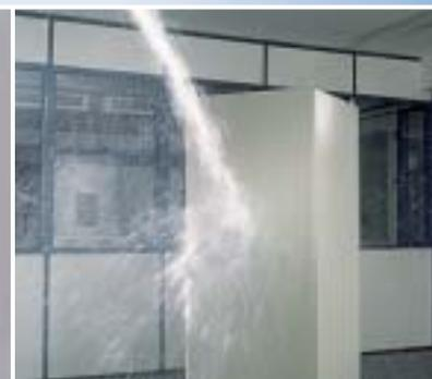
Outdoorfähige Steelen zur Fahrgastinformation, klimatisiert mit Luft/Luft-Wärmetauschern.
