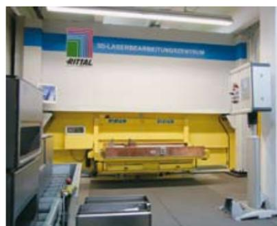
Der Rittal AE Laser Express bearbeitet das Werkstück in einem Arbeitsgang an fünf Seiten.
