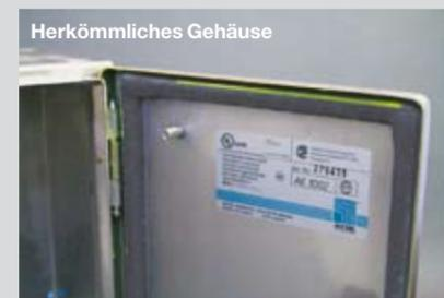
Durch eine Fluoreszenzauswertung wurden Rückstände auf der oberen Türdichtung und am Scharnier sichtbar gemacht
