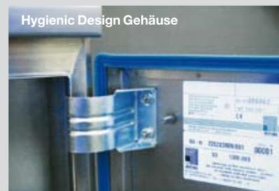
Trotz Fluoreszenzauswertung sind keine Rückstände an der Dichtung und am innen liegenden Scharnier sichtbar
